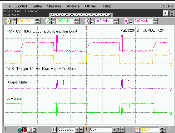
图 7-2. 6-V Amplitude PWM Pulse (TPS28225-Q1)
