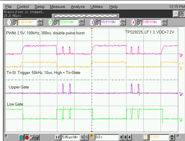
图 7-3. 2.5-V Amplitude PWM Pulse (TPS28225-Q1)
