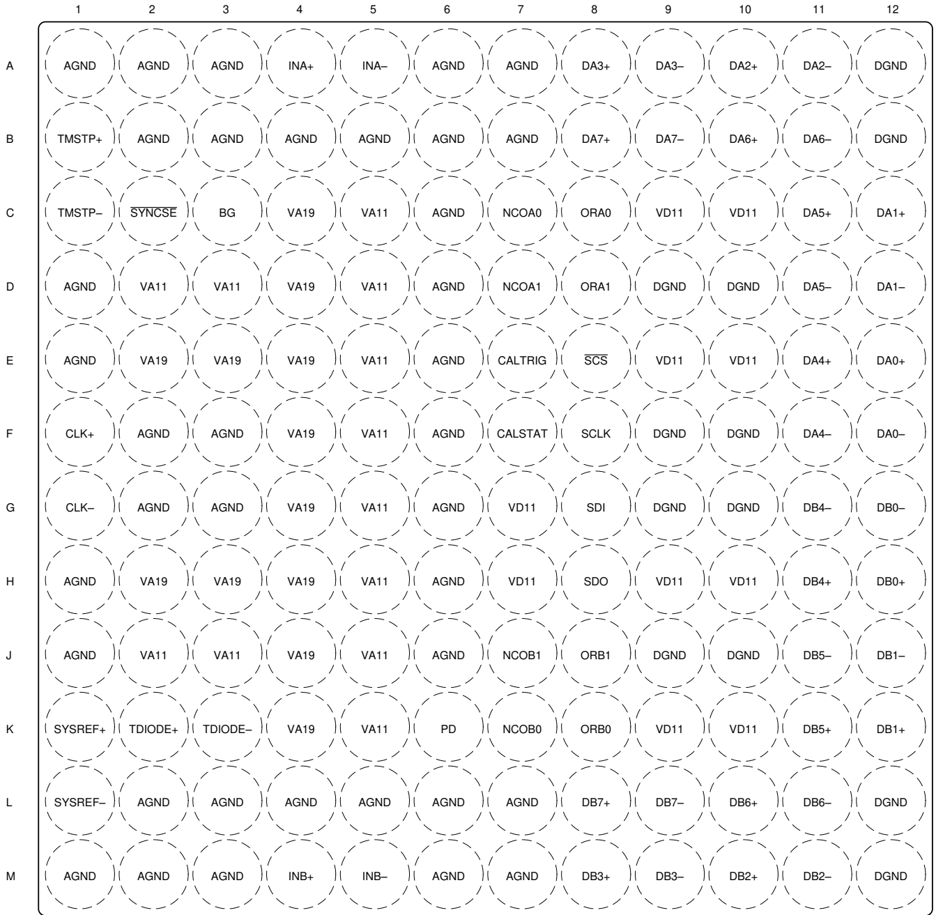
图 4-1. AAV Package, 144-Ball Flip Chip BGA Top View
