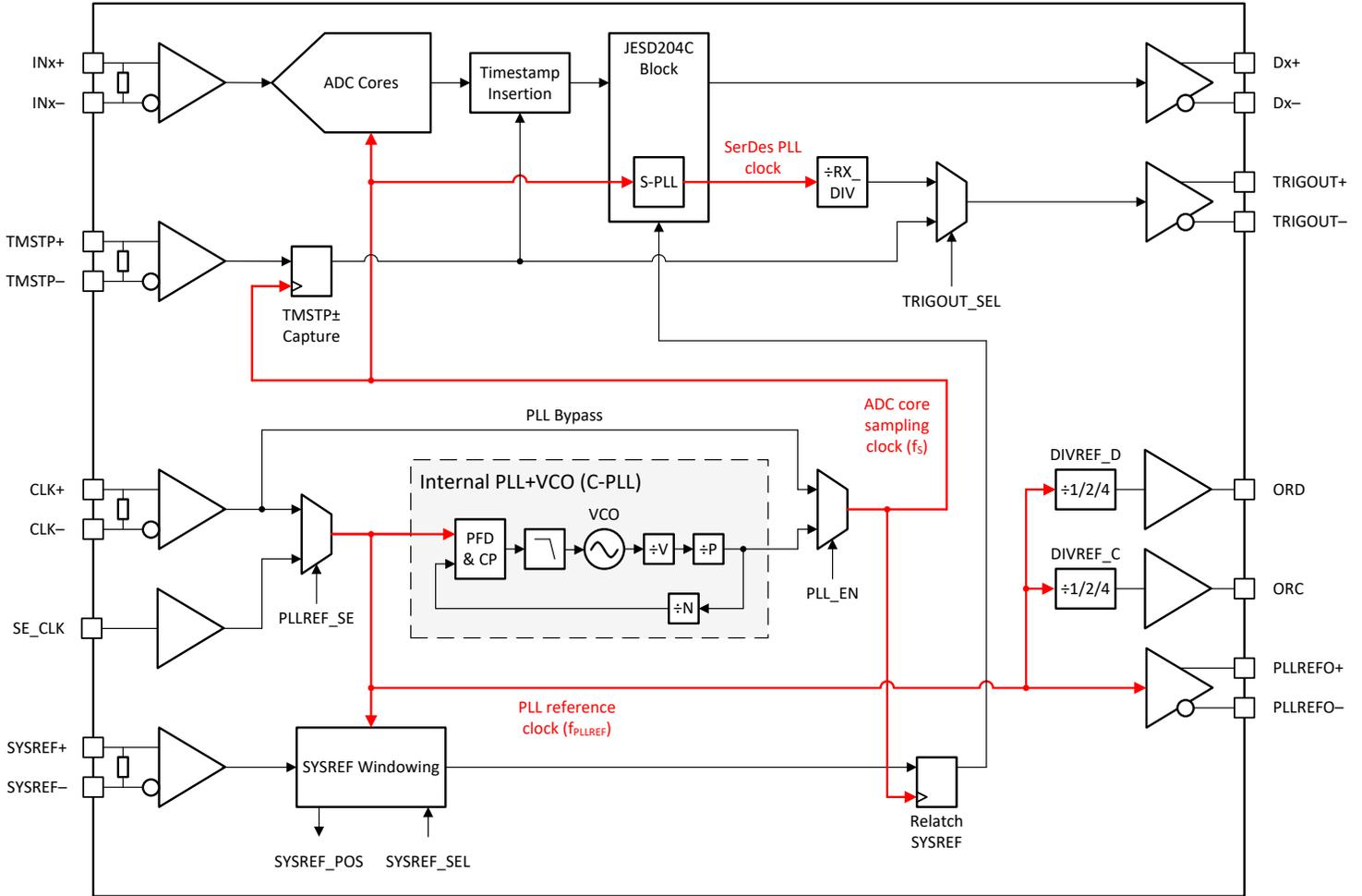
图 6-3. Clocking Subsystem
