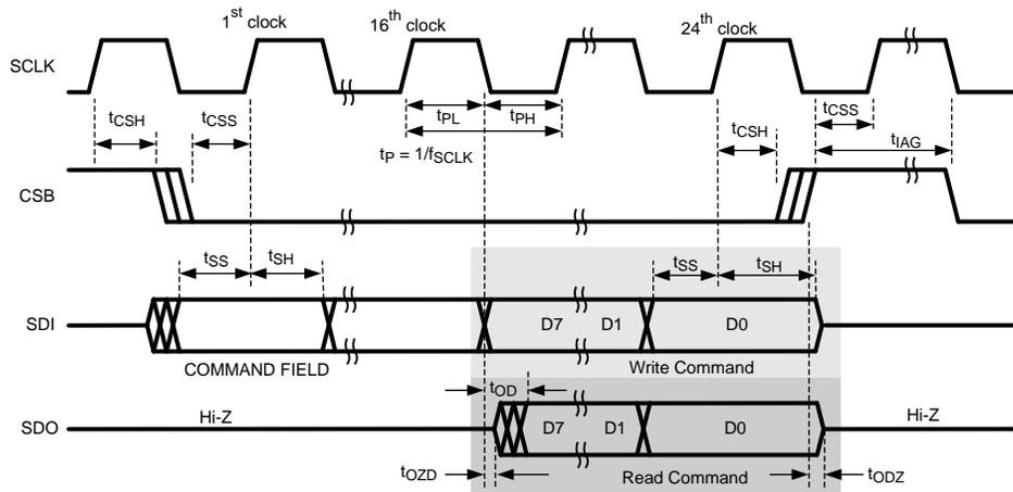
图 3. SPI Timing Diagram
