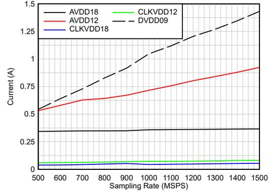
图 5-26. 电流与采样率间的关系
