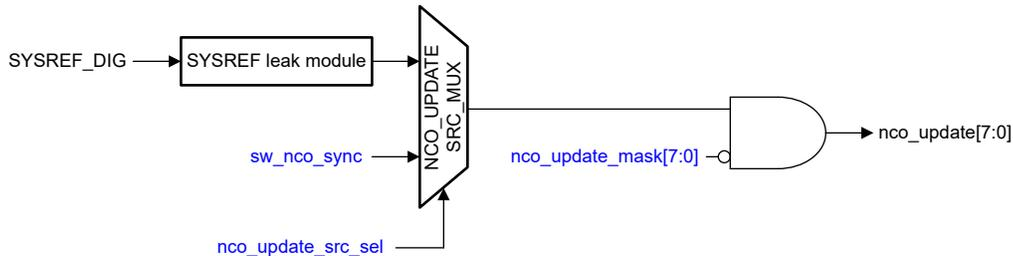
图 7-32. 使用所有控制信号进行 NCO 更新
