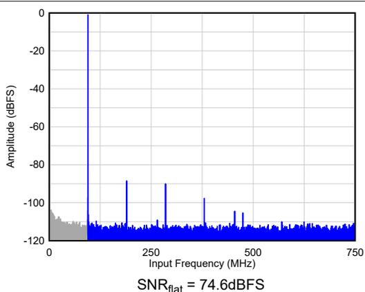
图 5-1.  $F_{IN} = 100\text{MHz}$  时的单音 FFT
