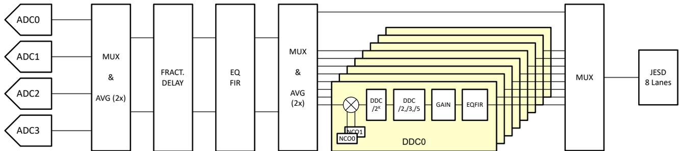
图 7-21. 多带抽取滤波器
