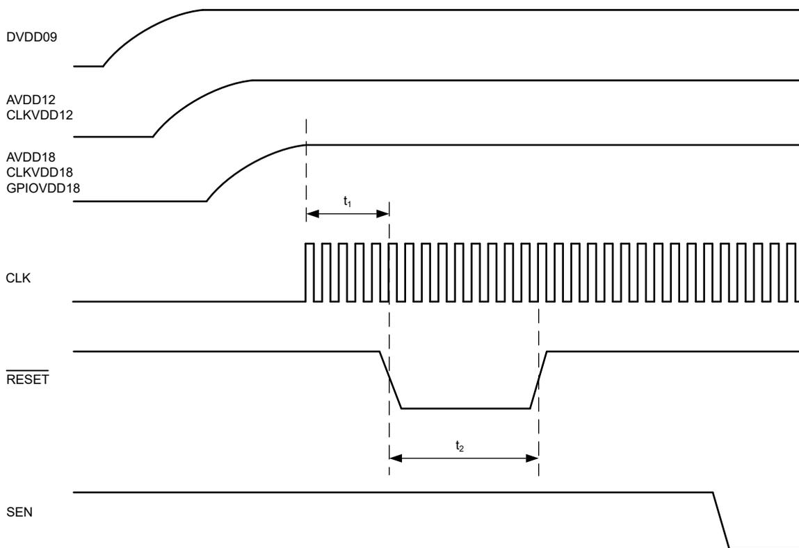
图 8-10. 上电后初始化串行寄存器
