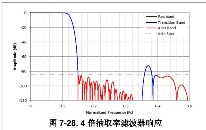
图 7-28. 4 倍抽取率滤波器响应
