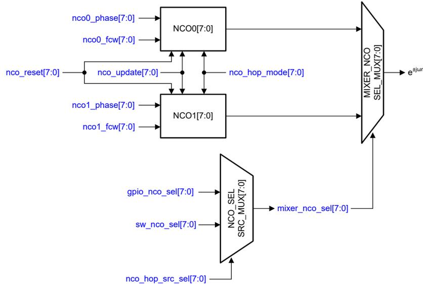
图 7-30. 包含所有控制信号的 NCO 方框图
