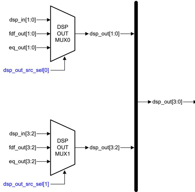
图 7-20. DSP 输出多路复用器
