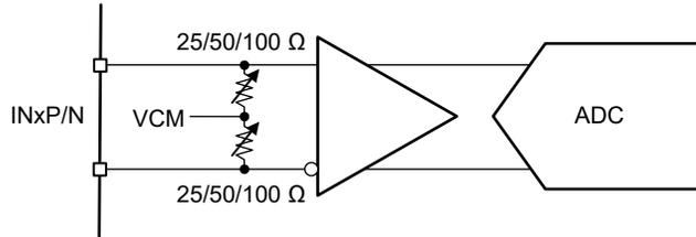
图 7-1. 模拟输入 (内部) 电路
