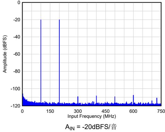
图 5-7.  $F_{IN} = 100\text{MHz}/200\text{MHz}$  时的双音 FFT
