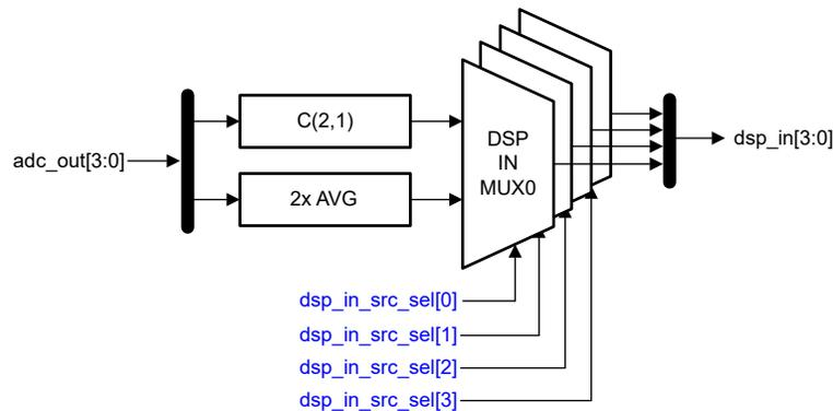
图 7-12. DSP 输入多路复用器概述
