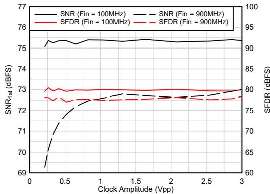
图 5-16. 交流性能与时钟振幅间的关系
