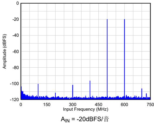
图 5-9.  $F_{IN} = 900\text{MHz}/1000\text{MHz}$  时的双音 FFT
