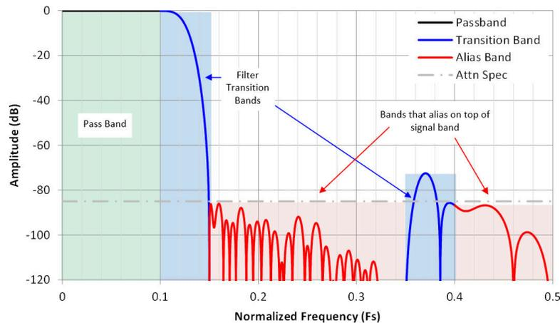
图 7-27. 抽取滤波器图的解释
