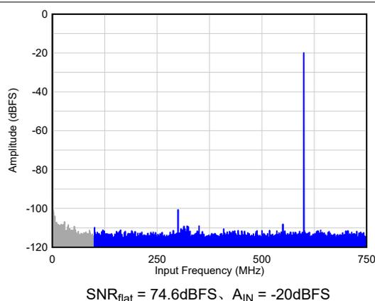
图 5-4.  $F_{IN} = 900\text{MHz}$  时的单音 FFT
