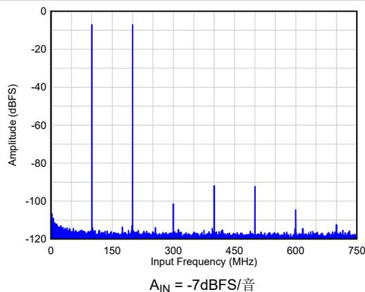
图 5-6.  $F_{IN} = 100\text{MHz}/200\text{MHz}$  时的双音 FFT
