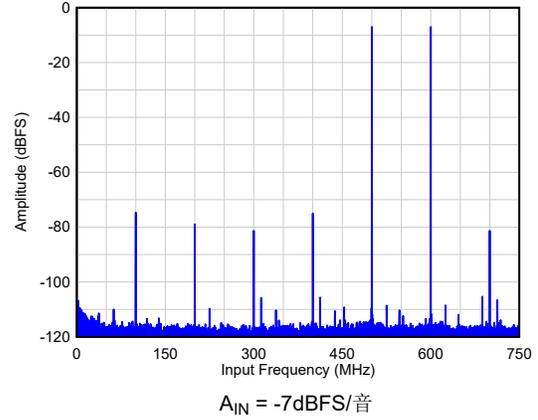
图 5-8.  $F_{IN} = 900\text{MHz}/1000\text{MHz}$  时的双音 FFT
