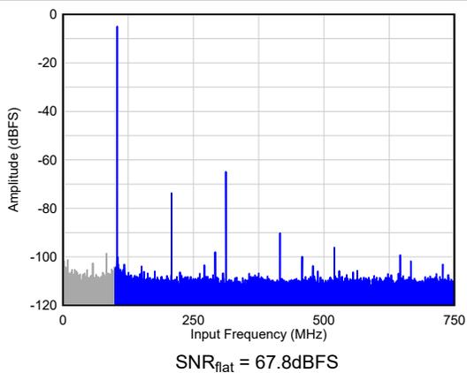
图 5-5.  $F_{IN} = 1400\text{MHz}$  时的单音 FFT
