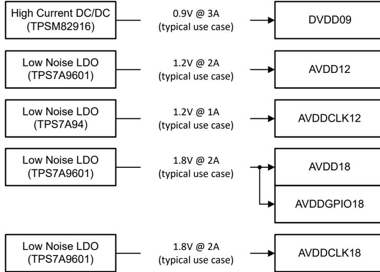
图 8-11. 电源轨和稳压器示例
