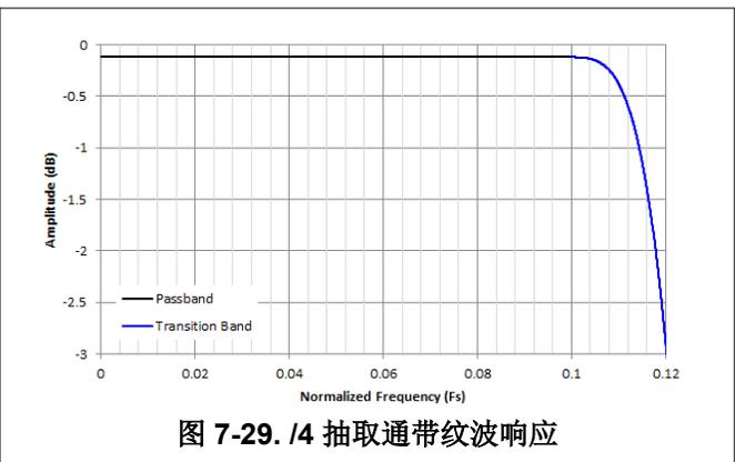
图 7-29. 1/4 抽取通带纹波响应
