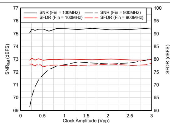
图 8-3. 交流性能与时钟振幅间的关系
