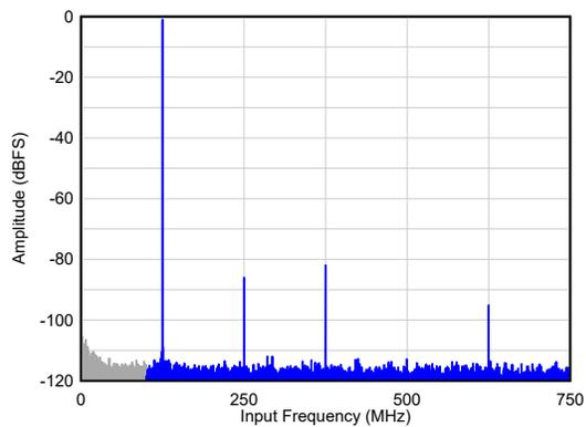
$F_{IN} = 125\text{MHz}$ 、 $A_{IN} = -1\text{dBFS}$ 、 $\text{SNR}_{\text{flat}} = 77.5\text{dBFS}$
