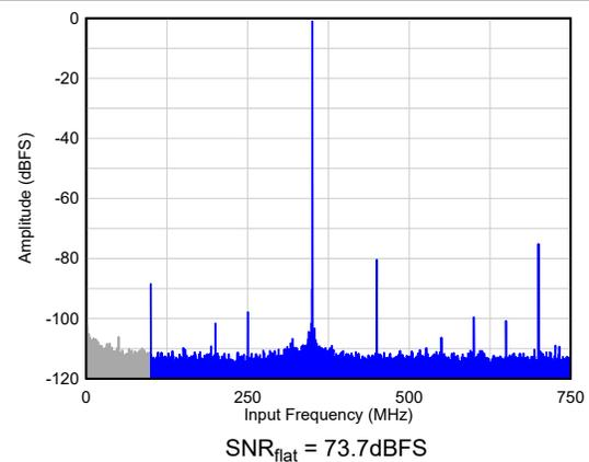
图 5-2.  $F_{IN} = 300\text{MHz}$  时的单音 FFT
