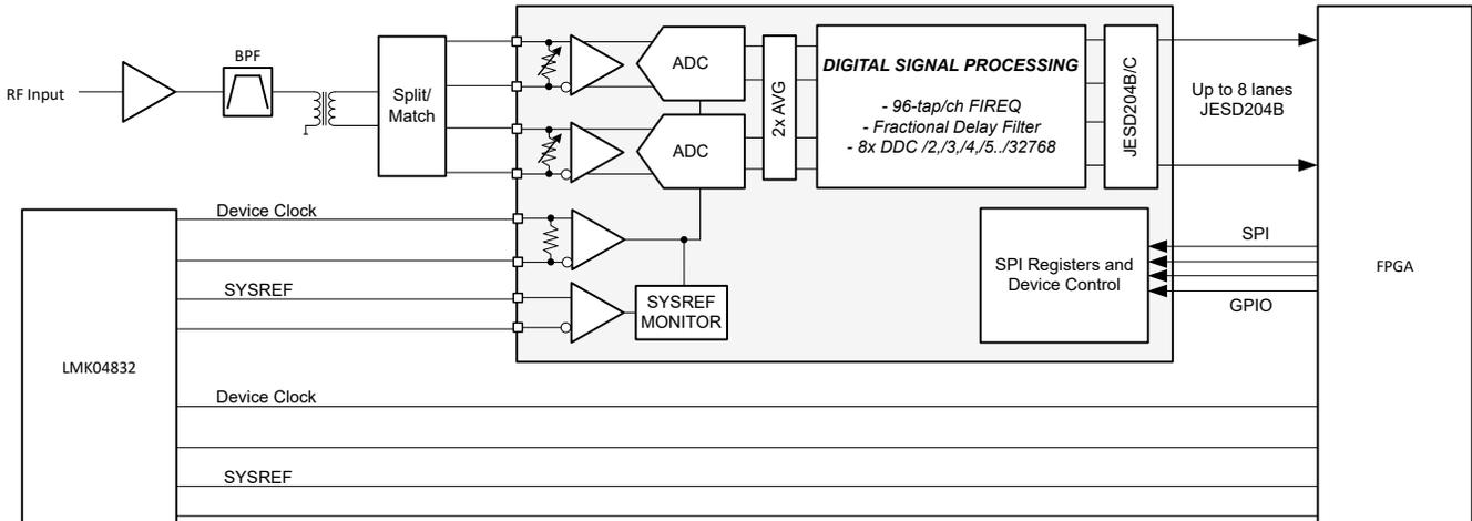
图 8-1. 宽带射频采样接收器
