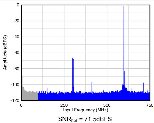
图 5-3.  $F_{IN} = 900\text{MHz}$  时的单音 FFT
