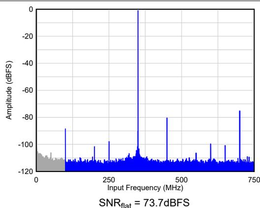
图 5-2.  $F_{IN} = 300\text{MHz}$  时的单音 FFT
