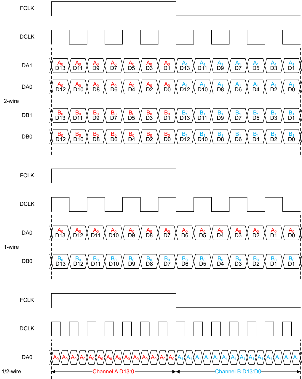
图 7-32. 实数抽取中的输出数据格式 ( 14 位输出分辨率 )
