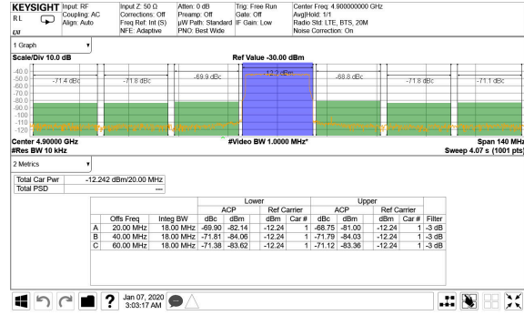
图 6-172. 4.9GHz 条件下的 TX 20MHz LTE 输出频谱
