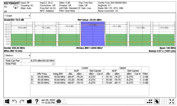
图 6-30. 0.85GHz 条件下的 TX 20MHz LTE 输出频谱
