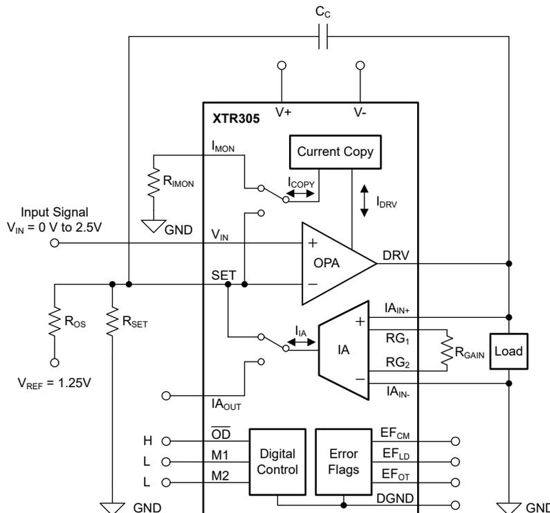
图 8-5. XTR305 电压输出标准电路
