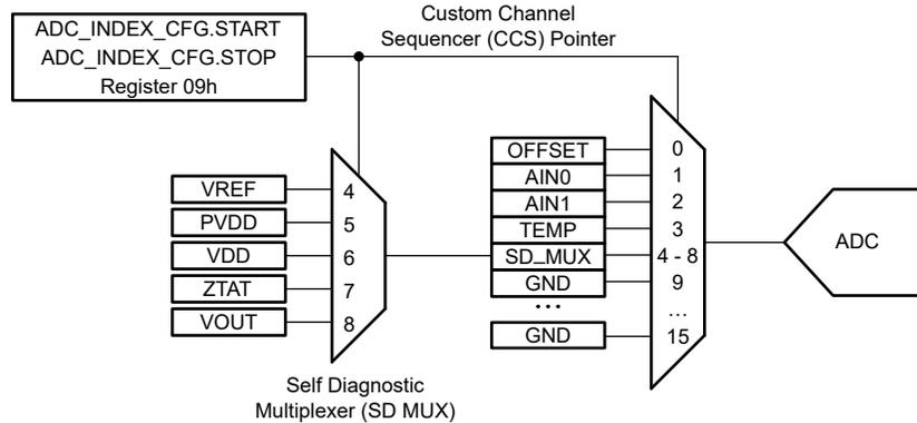
图 6-9. ADC 多路复用器控制
