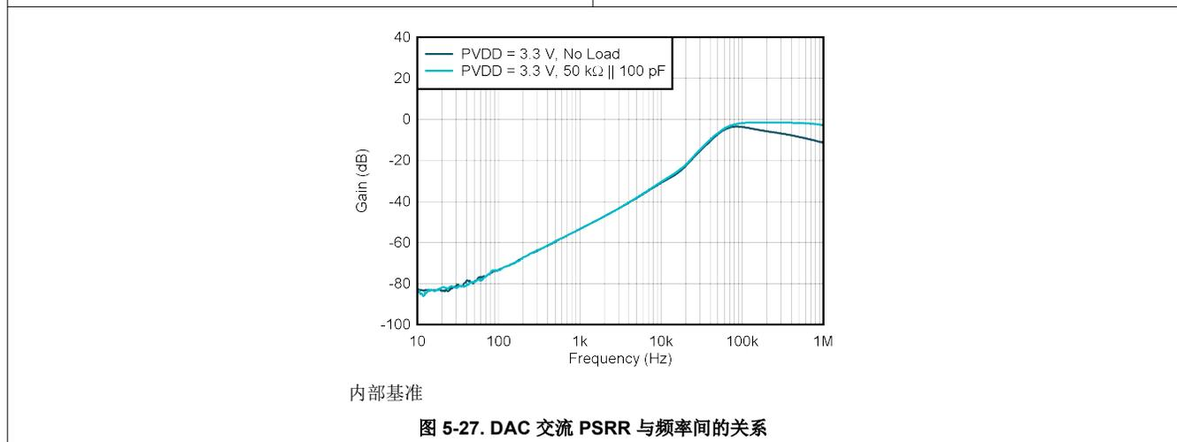
图 5-27. DAC 交流 PSRR 与频率间的关系
