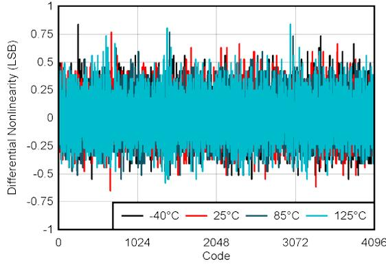
图 5-28. ADC DNL 与数字输入代码间的关系
