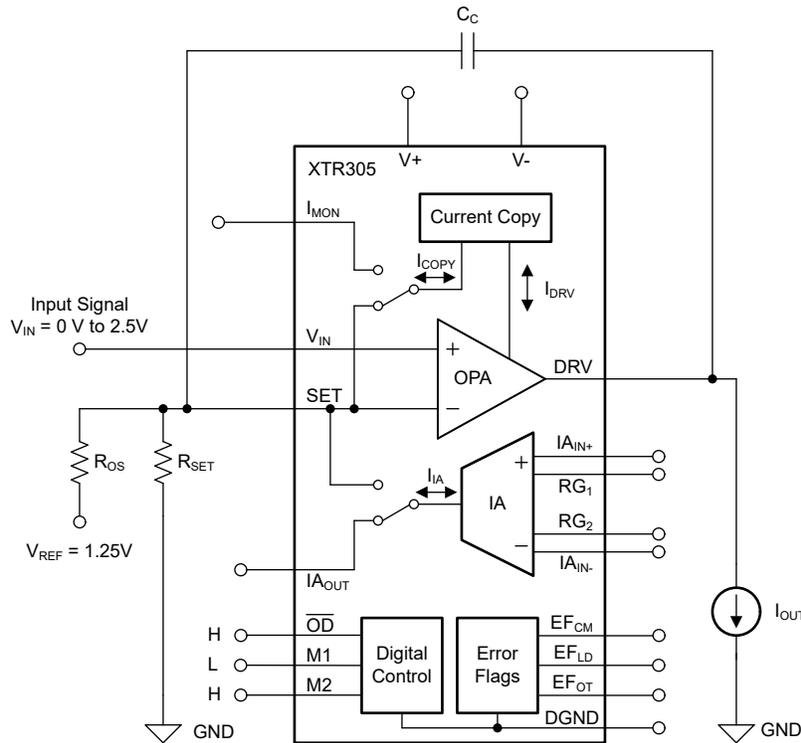
图 8-4. XTR305 电流输出标准电路
