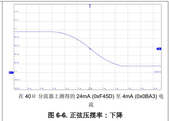
如果在 DAC 执行压摆率命令时禁用了压摆率功能，则会中止压摆率操作，且 DAC 输出将转至目标代码。
