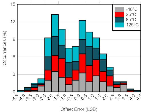
图 5-32. ADC 偏移误差与温度间的关系
