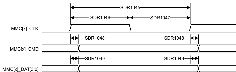
图 6-76. MMC1 – UHS-I SDR104 – 发送模式
