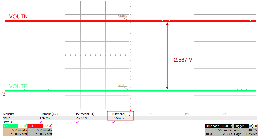
图 7-4. 典型的失效防护输出：AMC3311
