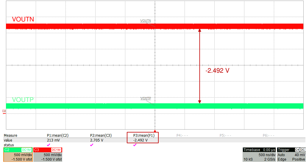
图 7-3. 典型的负削波输出：AMC3311
