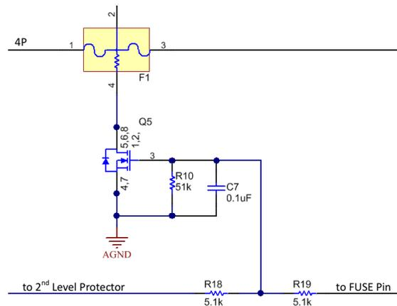
图 9-11. FUSE Circuit
