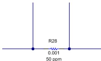
图 9-5. Sense Resistor
