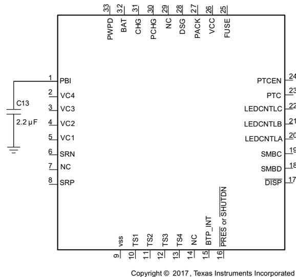
图 9-7. Power Supply Decoupling
