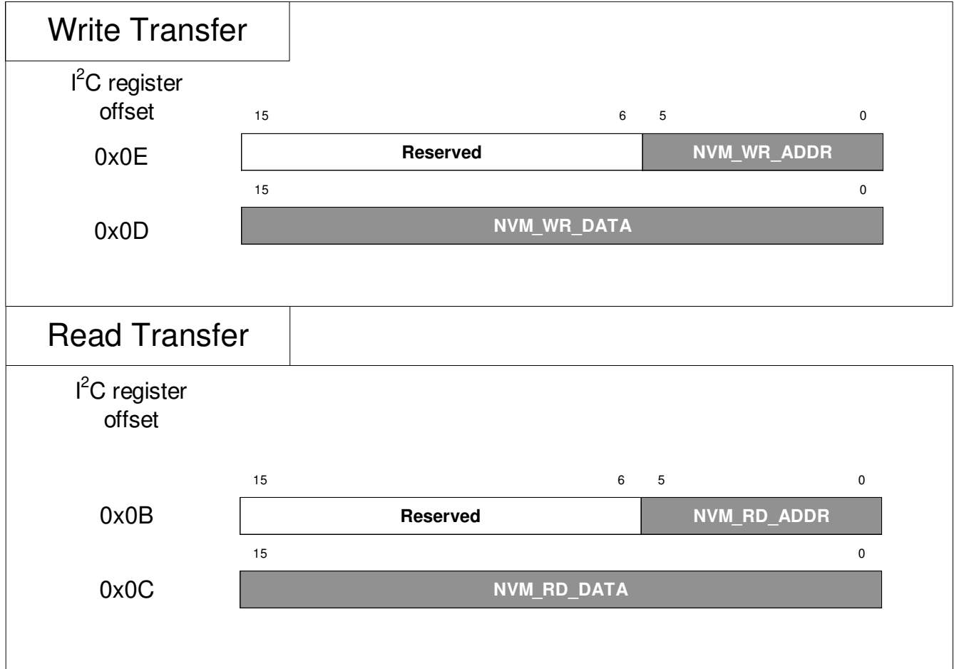
图 10-11. 使用 I 2 C 的 EEPROM 直接访问
