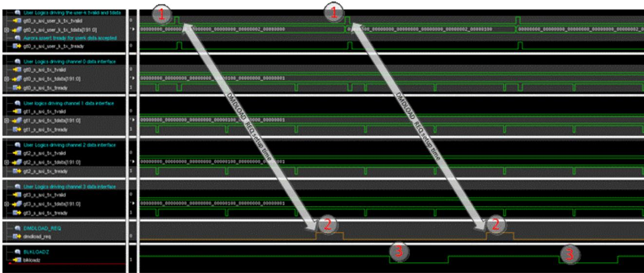
图 7-8. 块置位操作的 DMDLOAD\_REQ 建立时间示例
