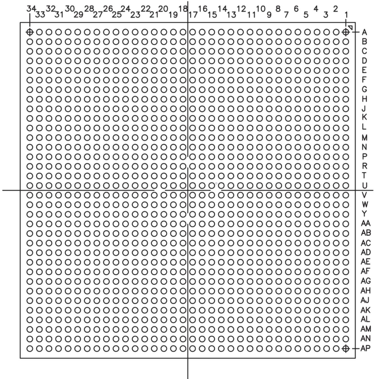
图 4-1. ZUM 封装，1156 引脚 FCBGA，底视图
