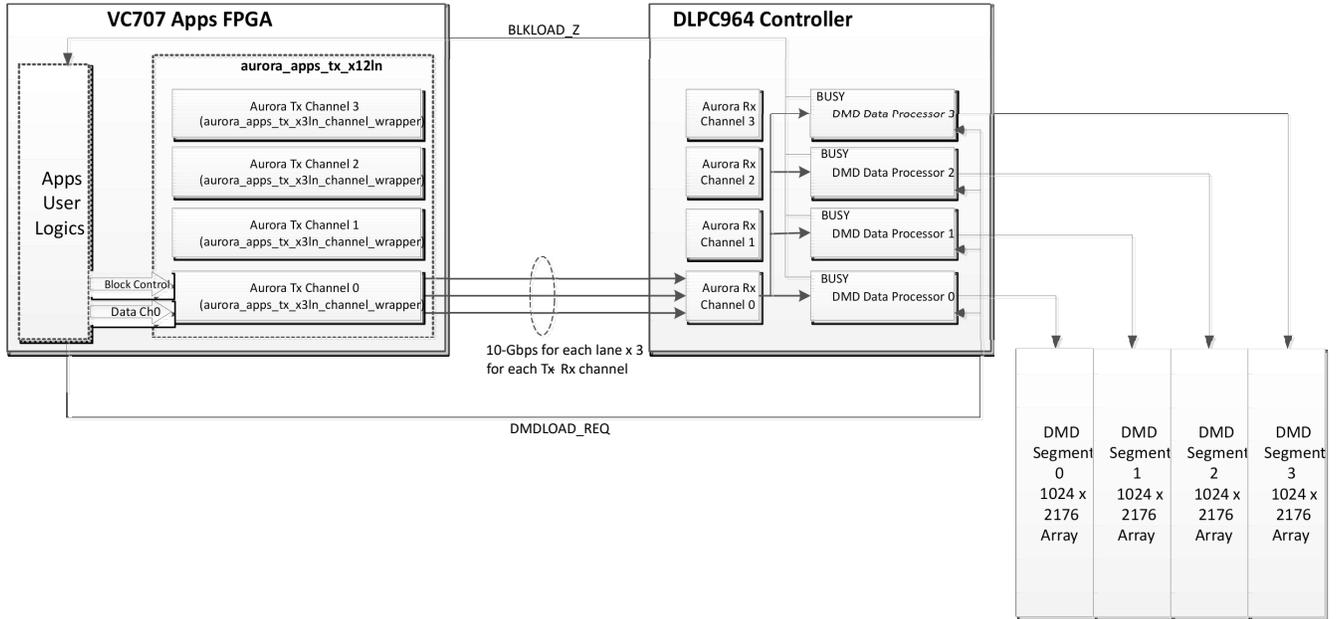
图 7-9. 单通道传输模式的系统方框图
