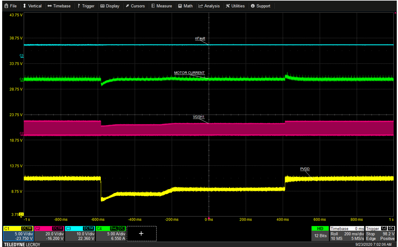
图 8-4. 热启动脉冲期间的驱动器 PWM 运行情况
