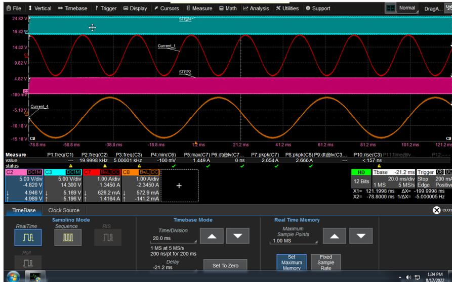
图 9-2. 驱动两个步进电机的 DRV8849
