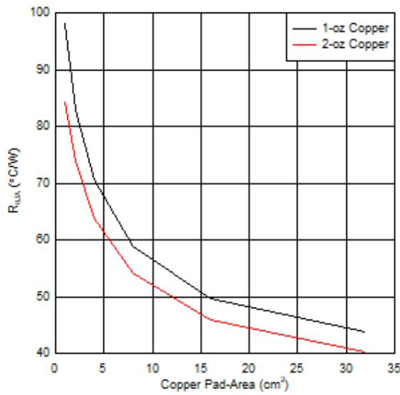
图 8-18. 4 层 PCB 结至环境热阻 (R<sub>θJA</sub>) 与覆铜区的关系
