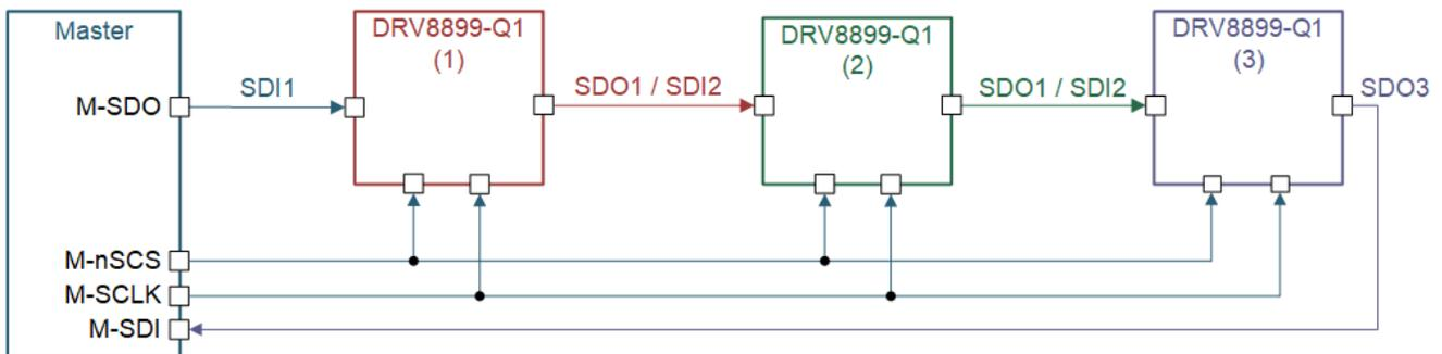
图 7-24. 在菊花链中连接的三个 DRV8899-Q1 器件
