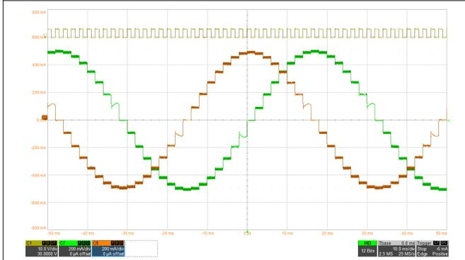
图 8-4. 智能调谐纹波控制衰减的 1/8 微步进
