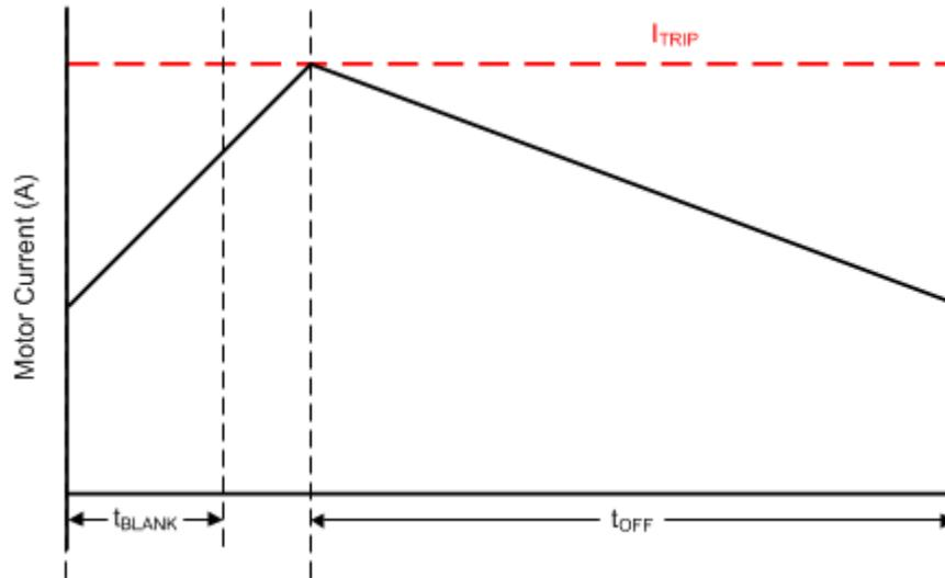
图 7-5. 电流斩波波形
