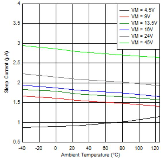
图 6-2. 睡眠电流与温度间的关系
