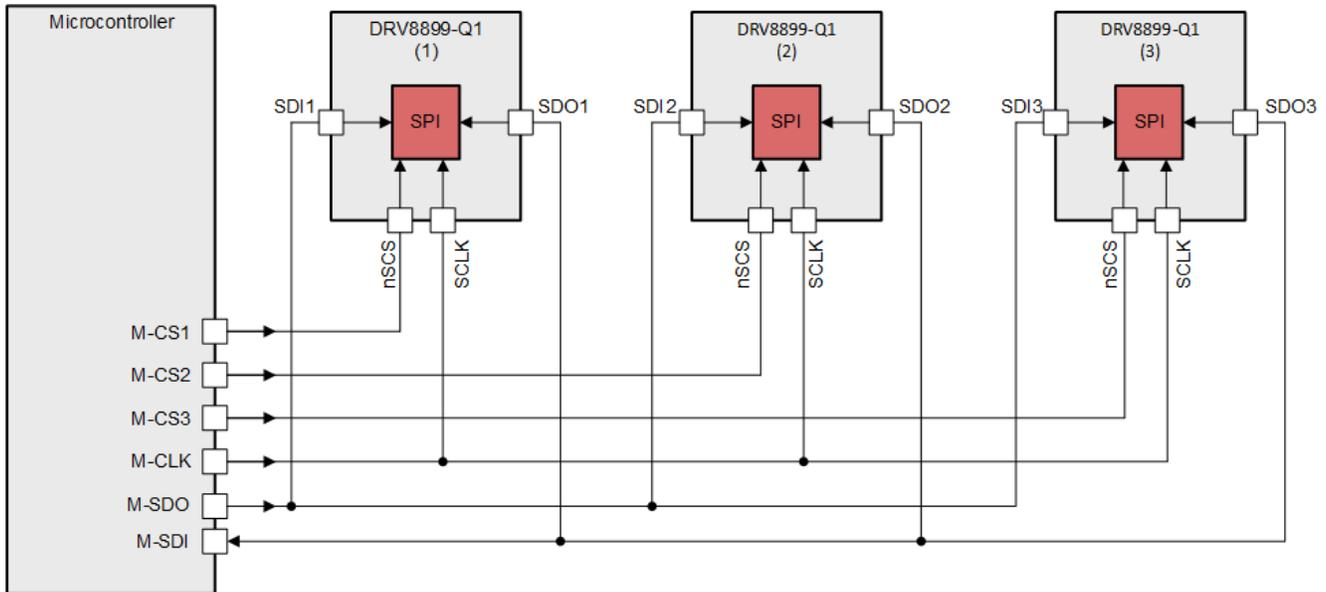
图 7-23. 并行配置连接的三个 DRV8899-Q1 器件
