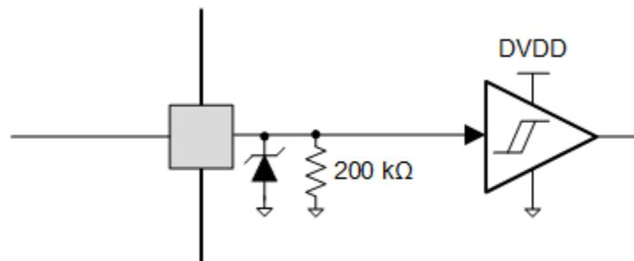
图 7-16. 逻辑电平输入引脚图
