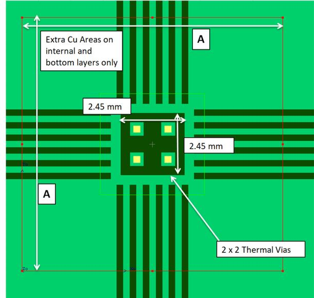
图 8-11. 适用于 VQFN 封装的 PCB - 顶层 ( 4/2 层 PCB )
