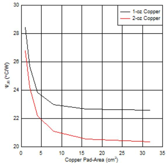
图 8-17. 2 层 PCB 结至电路板特征参数 ( $\Psi_{JB}$ ) 与覆铜区的关系
