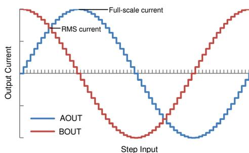
图 7-1. 满量程和均方根电流
