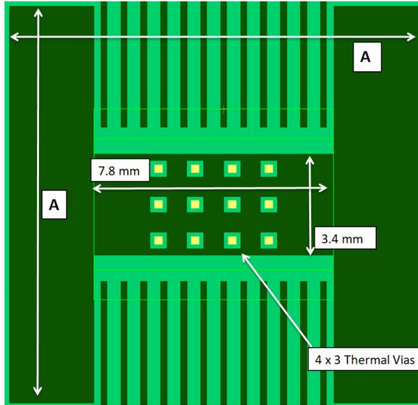
图 8-10. 适用于 HTSSOP 封装的 PCB - 顶层 ( 4/2 层 PCB )
