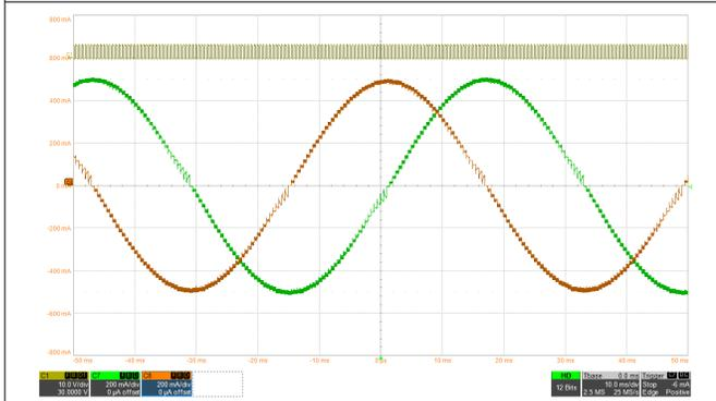
图 8-6. 智能调谐纹波控制衰减的 1/32 微步进
