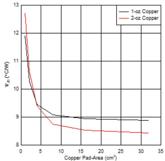
图 8-15. 4 层 PCB 结至电路板特征参数 ( $\Psi_{JB}$ ) 与覆铜区的关系
