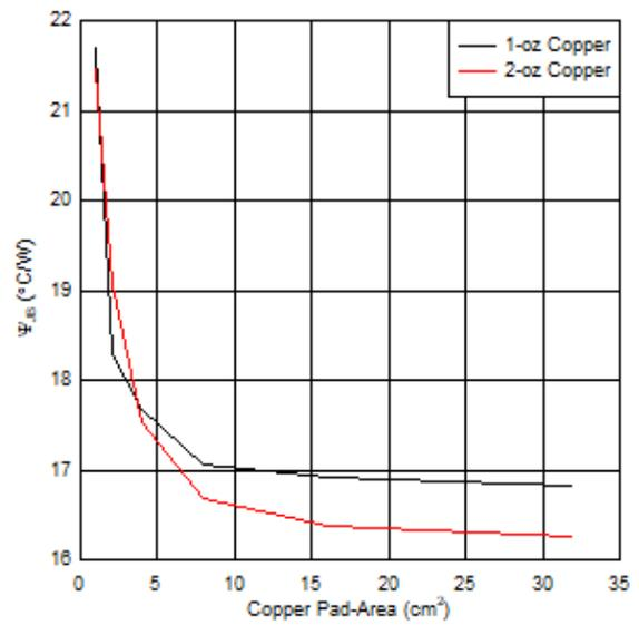
图 8-19. 4 层 PCB 结至电路板特征参数 (Ψ<sub>JB</sub>) 与覆铜区的关系
