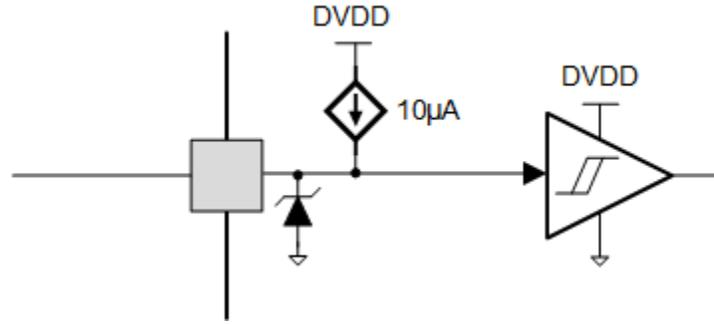
图 7-17. 带内部上拉的逻辑电平输入引脚图
