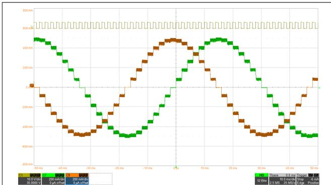
图 8-2. 混合 30 - 混合 30 衰减下的 1/8 微步进
