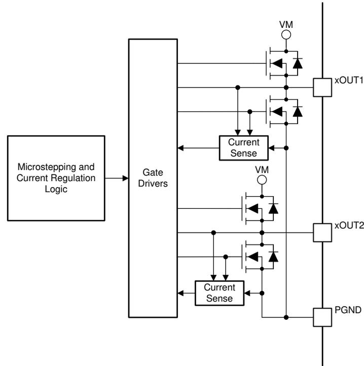
图 7-2. PWM 电机驱动器方框图
