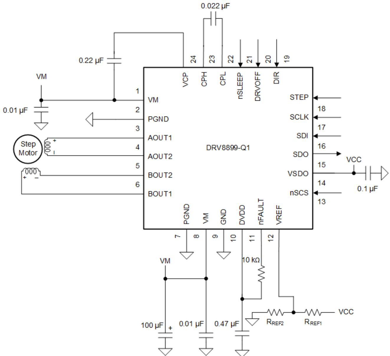
图 8-1. 典型应用原理图 (VQFN 封装)
