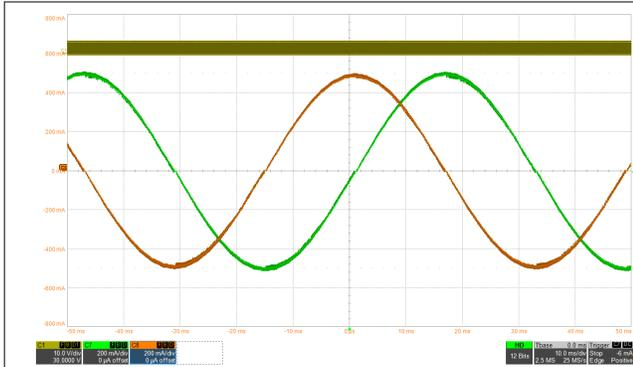
图 8-8. 智能调谐纹波控制衰减的 1/256 微步进
