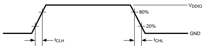
图 3. LVC MOS Transition Times
