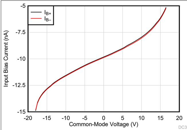
图 5-7. 输入偏置电流与共模电压间的关系
