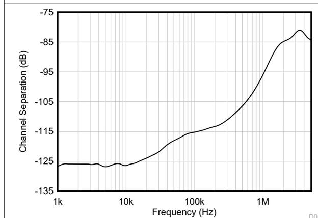
图 5-37. 通道隔离与频率间的关系
