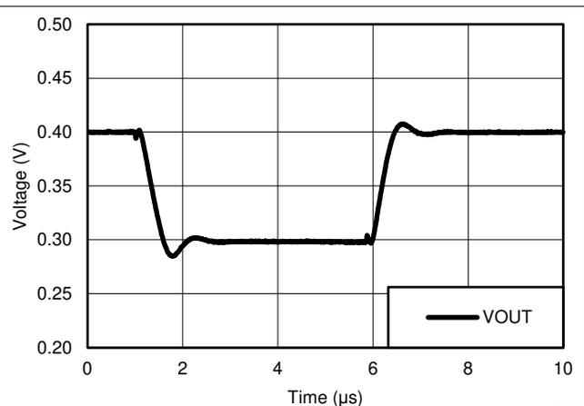
图 5-44. 电压跟随器小信号响应 (50pF)
