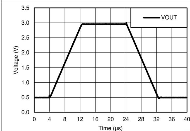
图 5-43. 电压跟随器大信号脉冲响应 (50pF)
