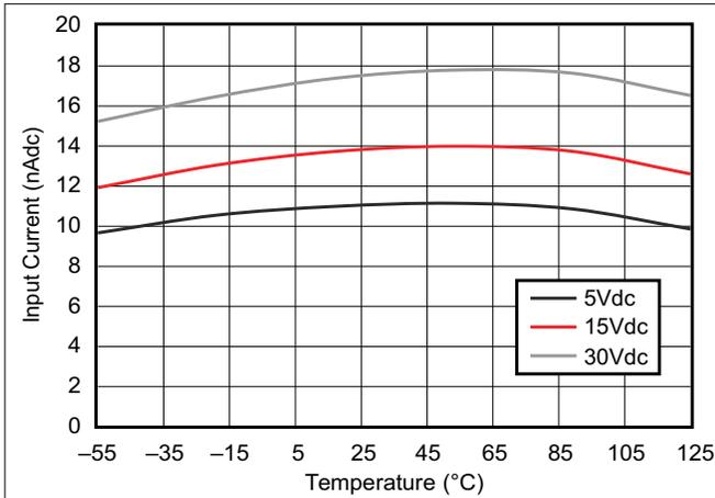
图 5-39. 输入电流与温度间的关系
