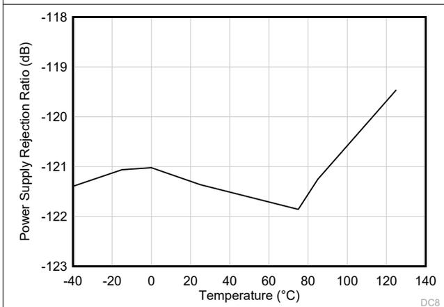
图 5-15. 电源抑制比与温度间的关系 (dB)
