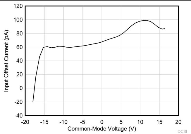
图 5-8. 输入失调电流与共模电压间的关系
