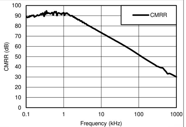
图 5-42. 共模抑制比与频率间的关系
