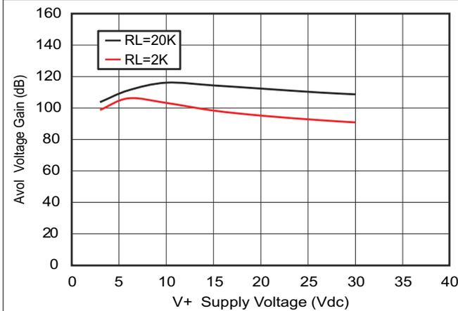
图 5-41. 电压增益与电源电压间的关系
