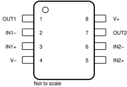
图 4-1. D、DDF、DGK、P、PS、PW 和 JG 封装
