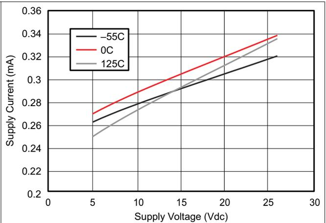
图 5-40. 电源电流与电源电压间的关系
