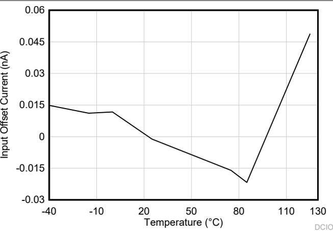
图 5-10. 输入失调电流与温度间的关系
