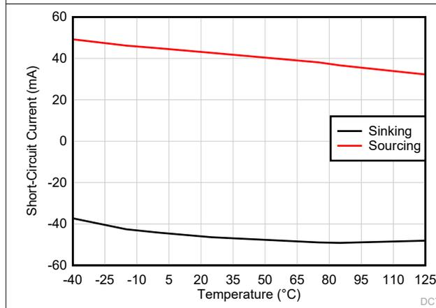
图 5-35. 短路电流与温度间的关系
