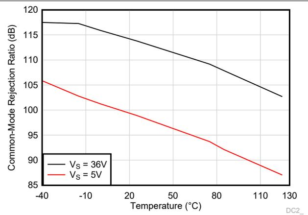
图 5-14. 共模抑制比与温度间的关系 (dB)
