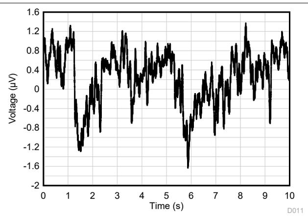
图 5-16. 0.1Hz 至 10Hz 噪声
