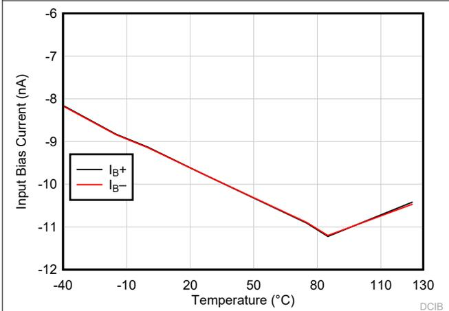
图 5-9. 输入偏置电流与温度间的关系
