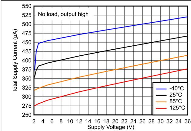
图 5-1. 总电源电流与电源电压之间的关系
