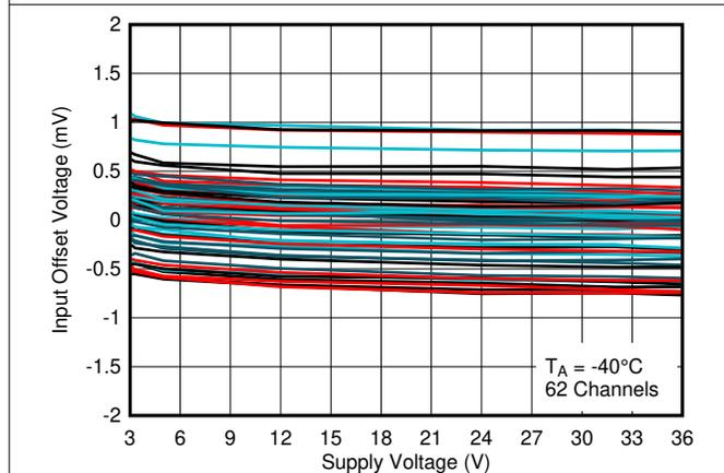
图 5-11. -40°C 下输入失调电压与电源电压之间的关系
