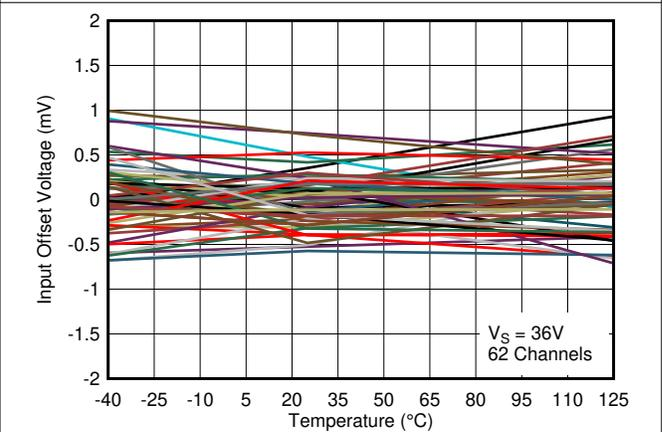
图 5-10. 36V 下输入失调电压与温度之间的关系
