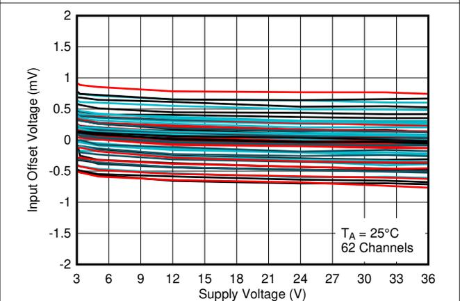
图 5-12. 25°C 下输入失调电压与电源电压之间的关系
