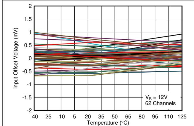
图 5-9. 12V 下输入失调电压与温度之间的关系
