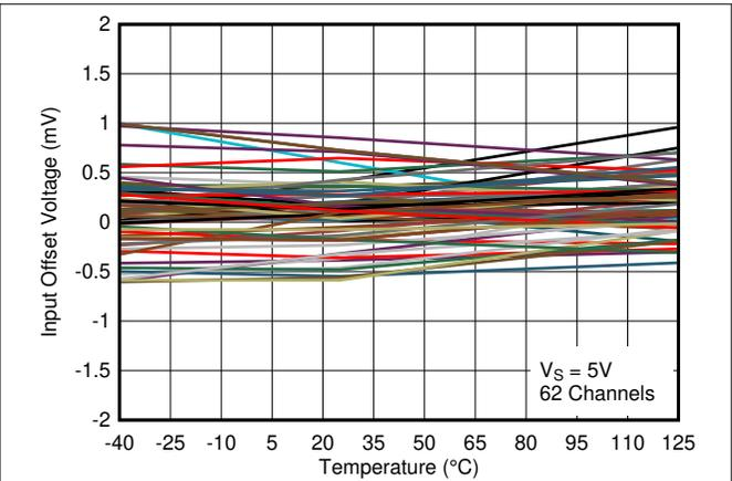
图 5-8. 5V 下输入失调电压与温度之间的关系
