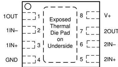
将散热焊盘直接连接到 GND 引脚。
