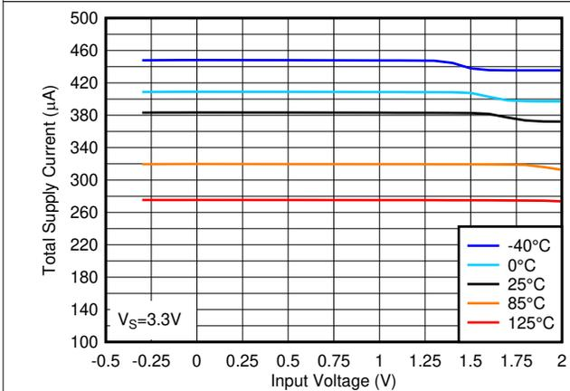
图 5-3. 3.3V 下总电源电流与输入电压之间的关系
