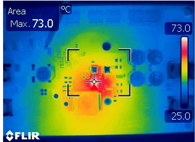
图 7-19. V_{in} = 14.4V , V_{out} = 45V , P_{OUT} = 150W , 自然对流
