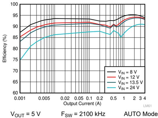
图 10-7. LM61440-Q1 Efficiency
