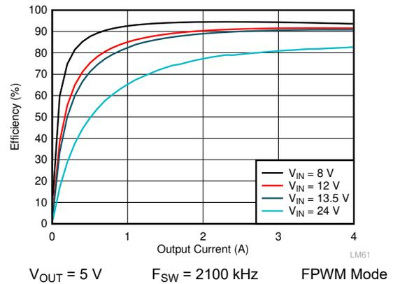
图 10-8. LM61440-Q1 Efficiency
