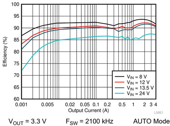
图 10-5. LM61440-Q1 Efficiency
