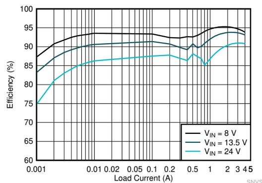
效率 : V<sub>OUT</sub> = 5V, F<sub>SW</sub> = 2200kHz
