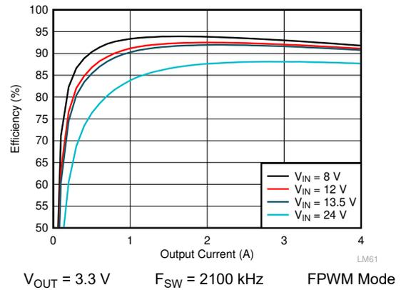
图 10-6. LM61440-Q1 Efficiency
