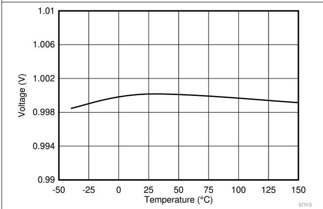
图 7-3. Feedback Voltage
