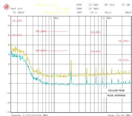
传导 EMI：V<sub>OUT</sub>=5V，f<sub>SW</sub>=2100kHz
