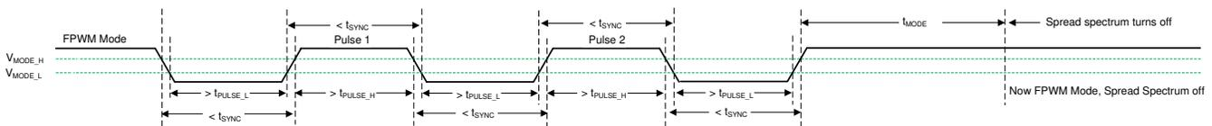
图 8-6. Spread Spectrum Disabled in FPWM Mode
