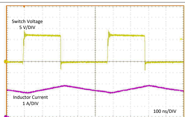
图 7-7. 没有展频的典型 PWM 开关波形， V_{IN} = 12V ， V_{OUT} = 5V ， I_{OUT} = 2.5A ， f_{SW} = 2100kHz
