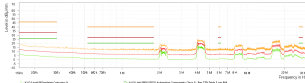
V_{OUT} = 3.3V F_{SW} = 2100kHz I_{OUT} = 12A 测试频率：150kHz 至 30MHz
