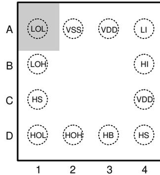
图 5-1. YFX Package 12-Pin DSBGA Top View
