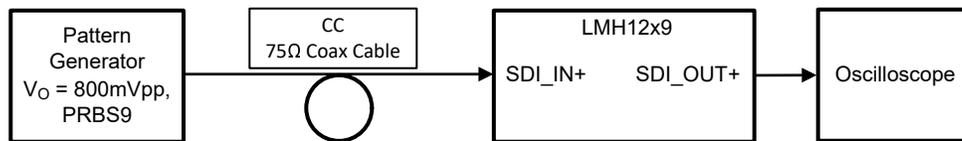
图 7-5. LMH12x9 环通 (SDI\_OUT+) 的测试设置
