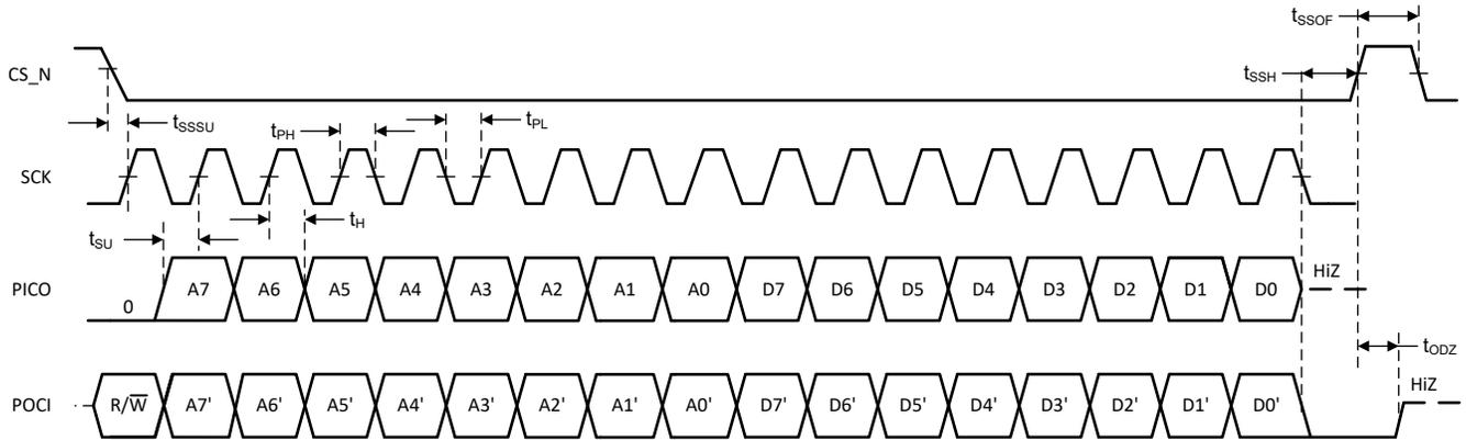
图 6-7. SPI 写事务的信号时序
