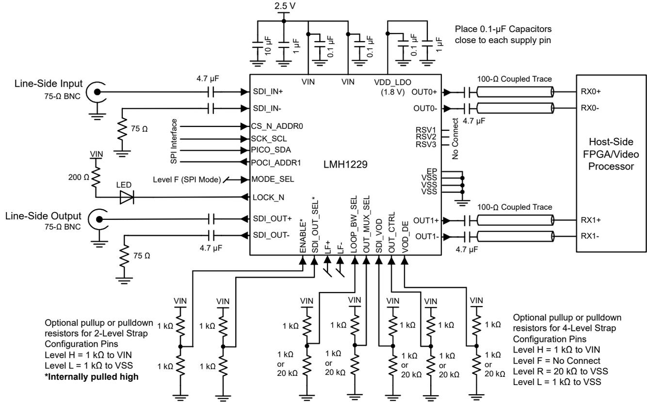
图 7-2. LMH12x9 SPI 模式连接图
