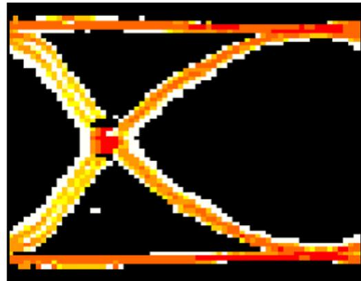
图 6-2. 内部眼图监视器点密度曲线图
