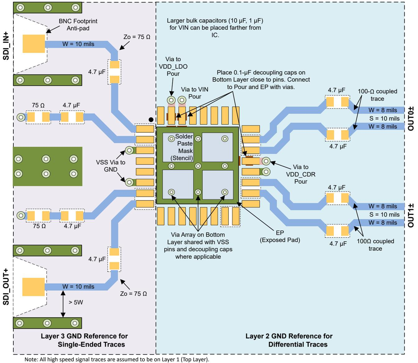
图 7-21. LMH12x9 高速布线布局示例
