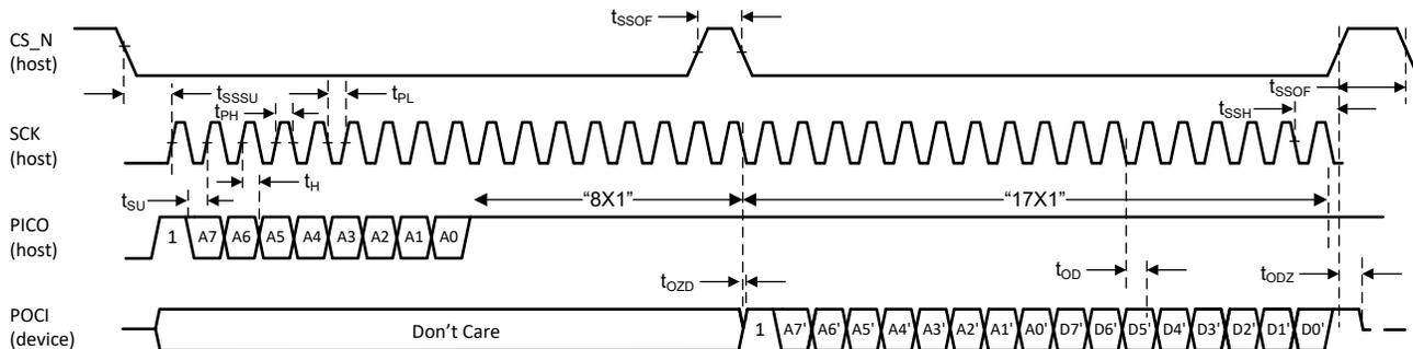
图 6-8. SPI 读事务的信号时序
