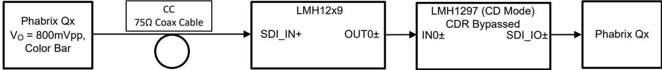
图 7-6. LMH12x9 BER 性能的测试设置 (OUT0±)
