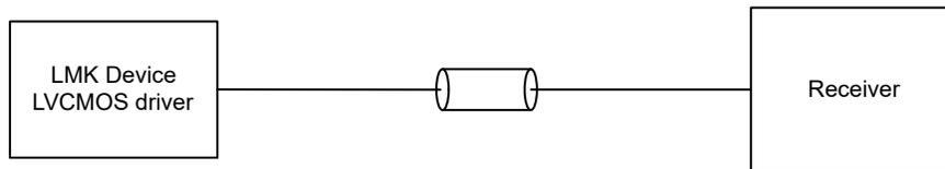
图 8-23. LVCMOS Output Termination
