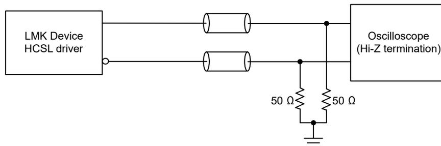
图 7-7. HCSL Output Time Domain Test Configuration
