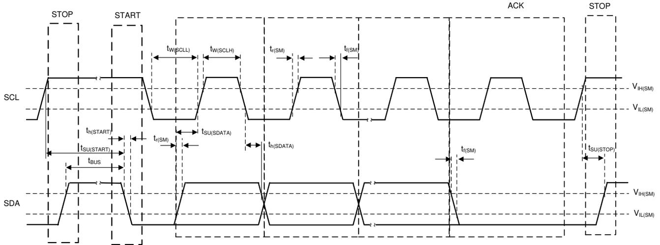
图 6-4. I<sup>2</sup>C Timing Diagram
