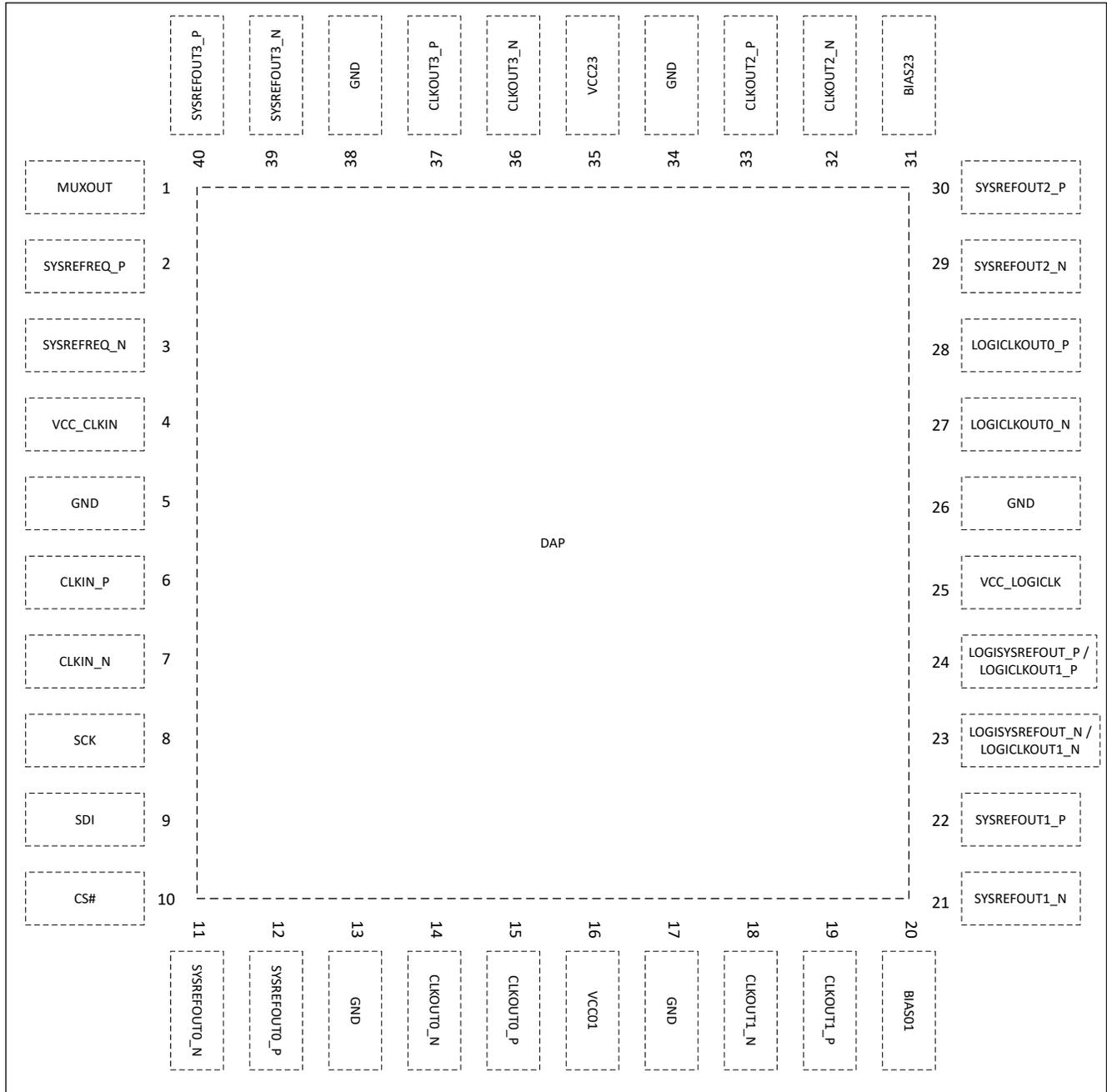
图 4-1. RHA 封装 40 引脚 VQFN 顶视图
