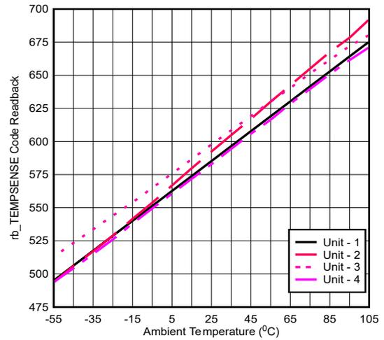
在断电模式下测量，目的使结温 = 环境温度
