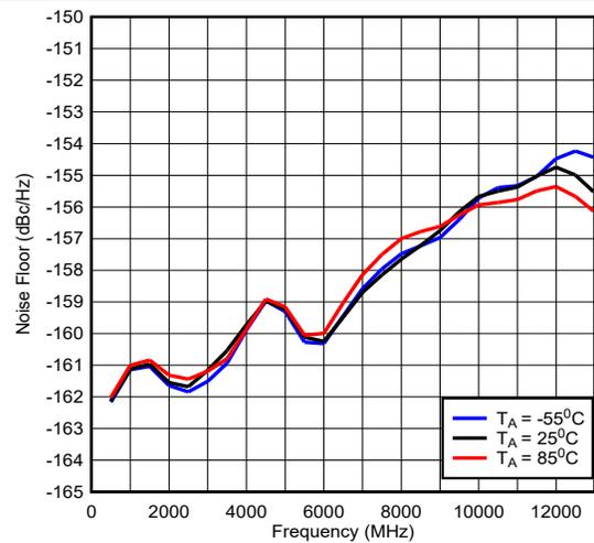
图 5-5. 缓冲器模式下的本底噪声
