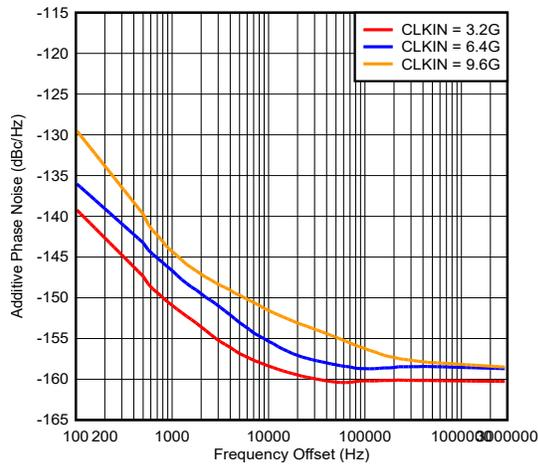
图 5-6. 缓冲器模式下的闪烁噪声
