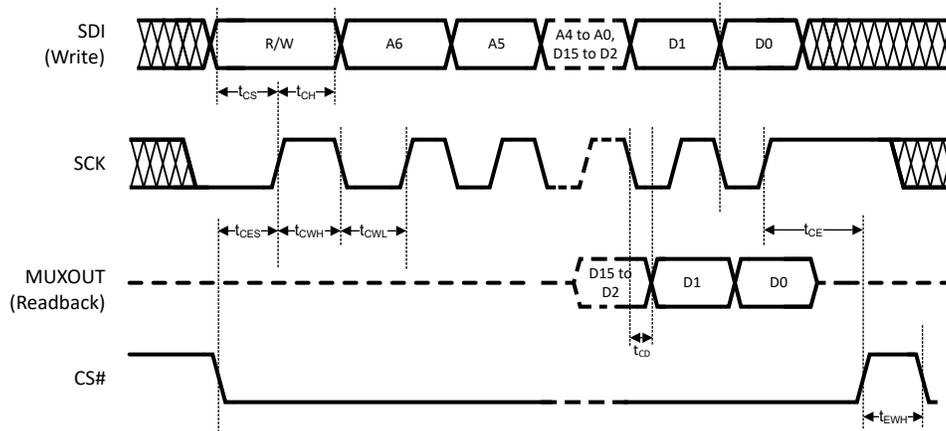
图 5-1. 串行数据输入时序图
