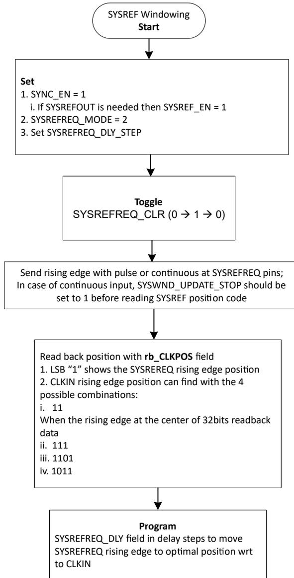
图 6-12. SYSREF 窗口化操作流程
