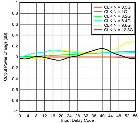
图 5-19. 相对于输入延迟代码的输出功率
