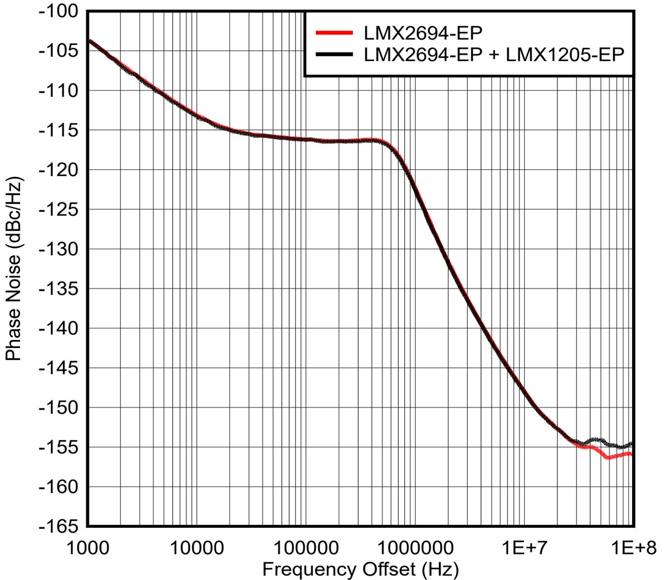
图 8-3. LMX1205-EP 缓冲器模式输出
