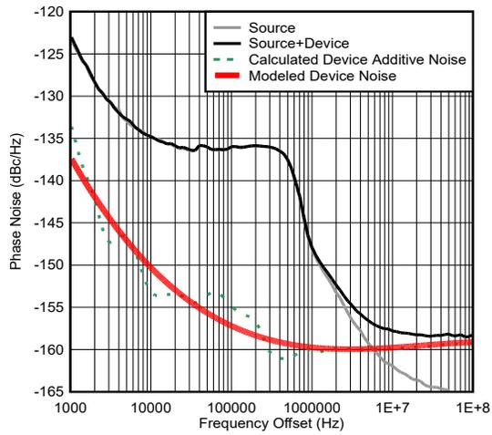
图 5-2. 6.4GHz 输出、缓冲器模式下的相位噪声图
