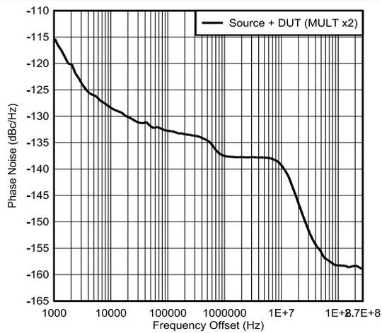
图 5-4. 6.4GHz 输出、倍频器模式下的相位噪声图
