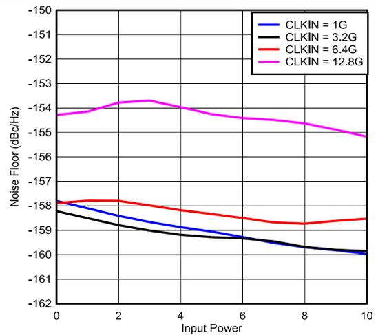
图 5-9. 缓冲器模式下的本底噪声
