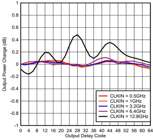
图 5-20. 相对于输出延迟代码的输出功率
