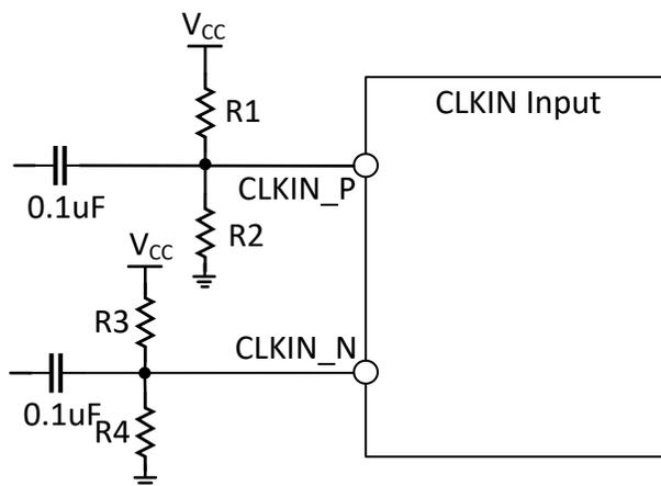
图 6-2. CLKIN 输入引脚外部偏置网络
