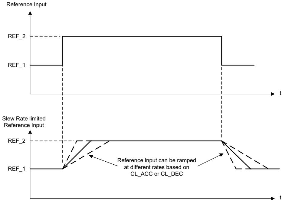
图 6-28. 闭环加速/减速压摆率
