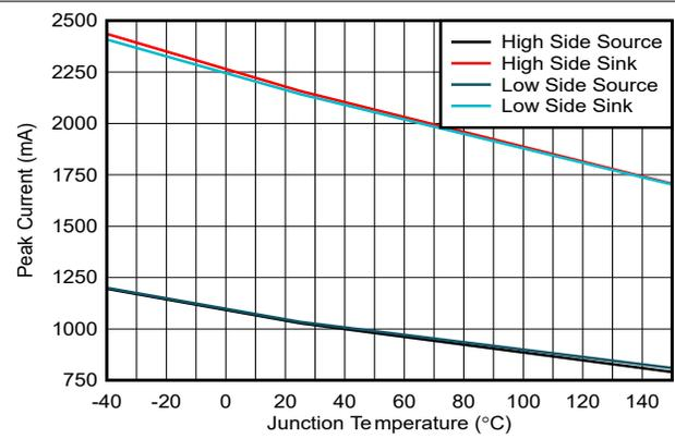
图 5-2. 驱动器峰值电流与结温之间的关系
