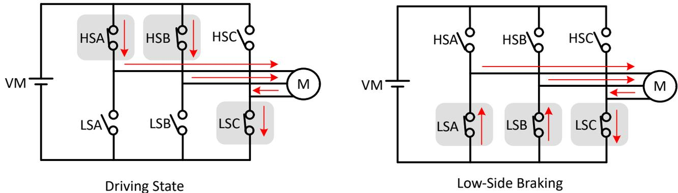
图 6-42. 低侧制动
