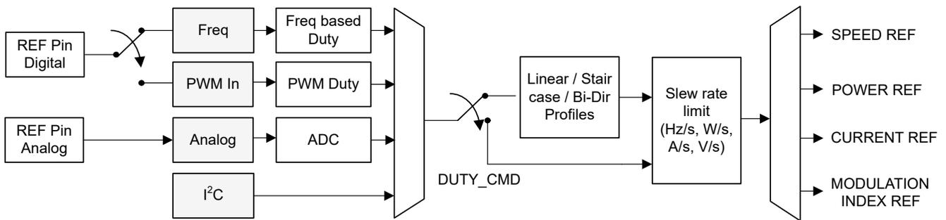
图 6-4. 多路复用基准输入命令
