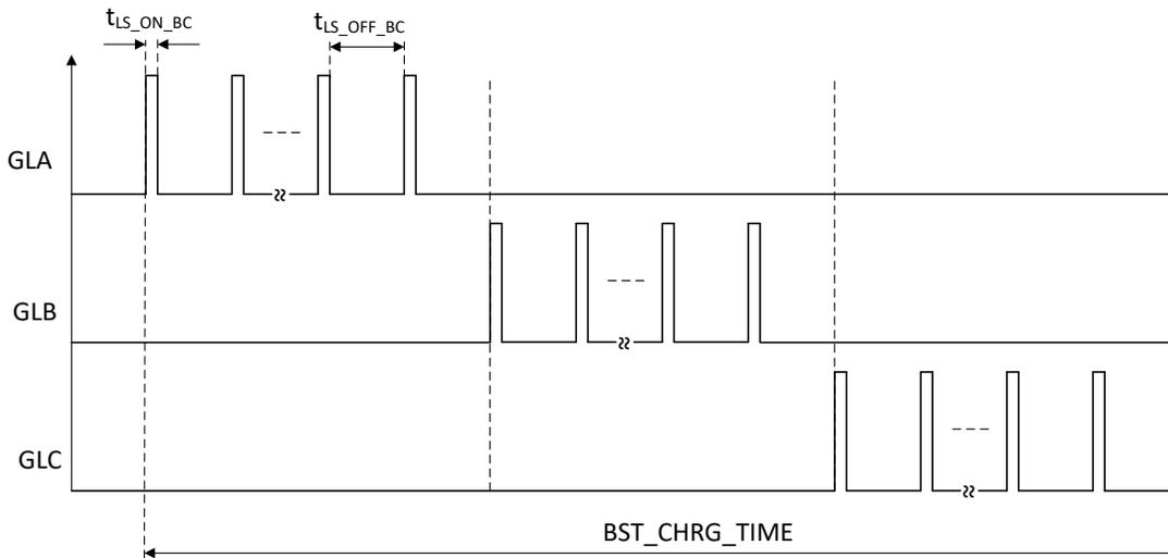
图 6-17. 启动时对自举电容器进行预充电
