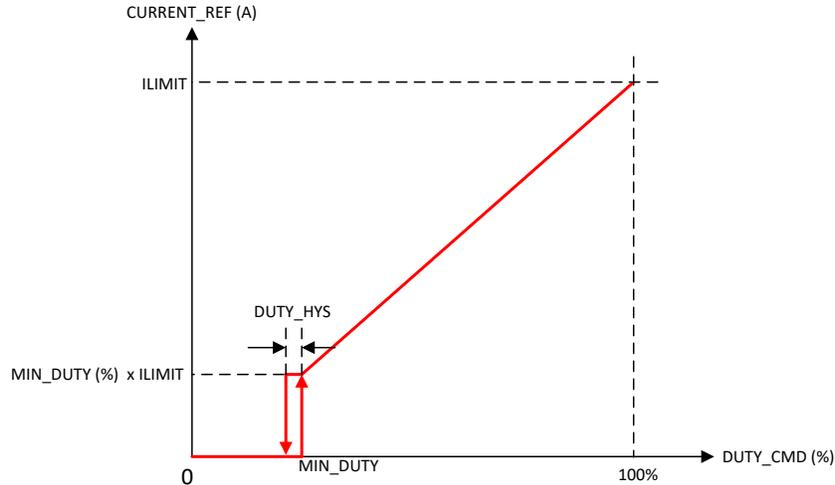
图 6-16. 电流基准传递函数
