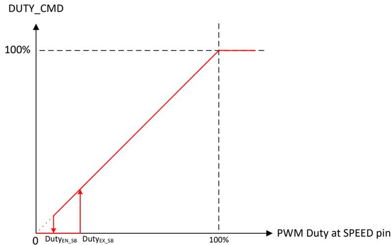
图 6-6. PWM 模式电机控制
