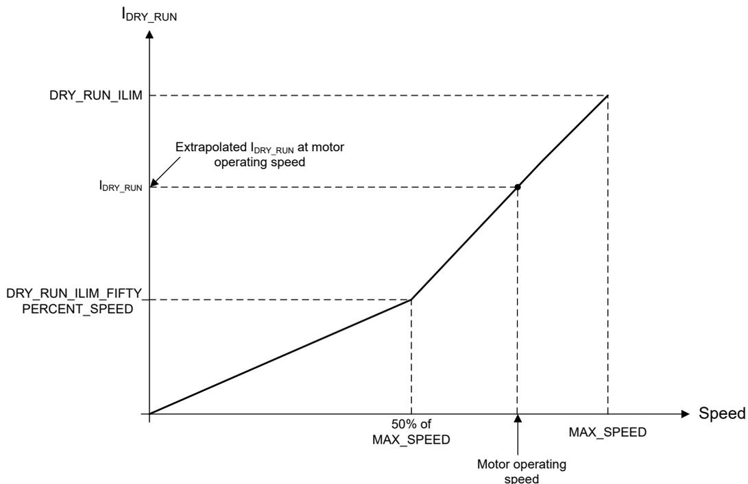
图 6-48. 用于空运行检测的可变电流阈值 ( $I_{DRY\_RUN}$ )
