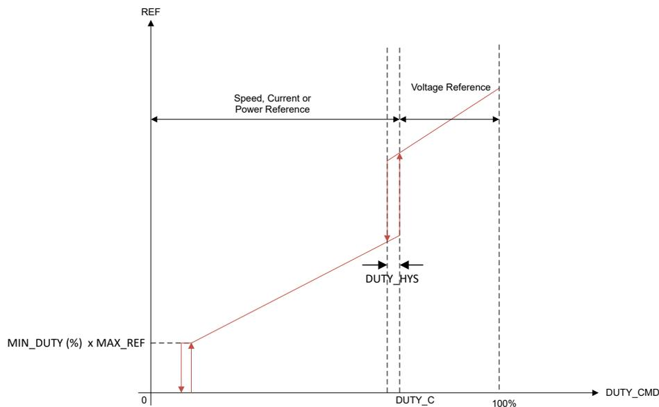
图 6-11. 多基准模式运行（当 MIXED\_MODE\_CONFIG = 01b 时）
