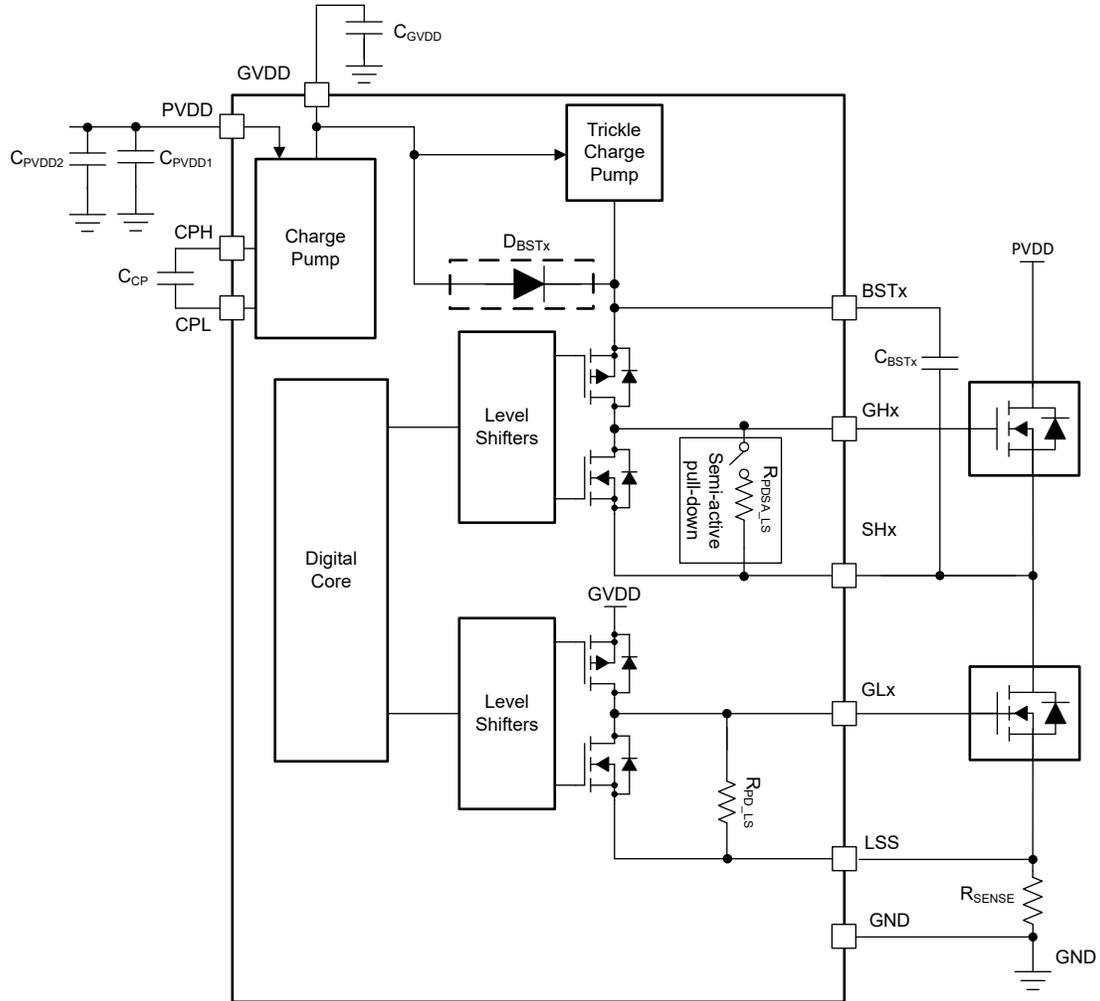
图 6-2. 栅极驱动器方框图
