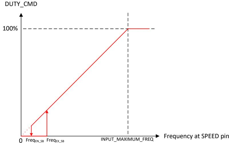
图 6-7. 频率模式电机控制
