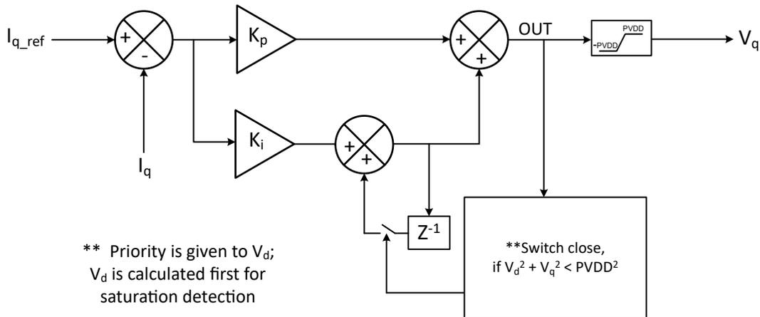
图 6-31.  $I_q$  电流 PI 控制
