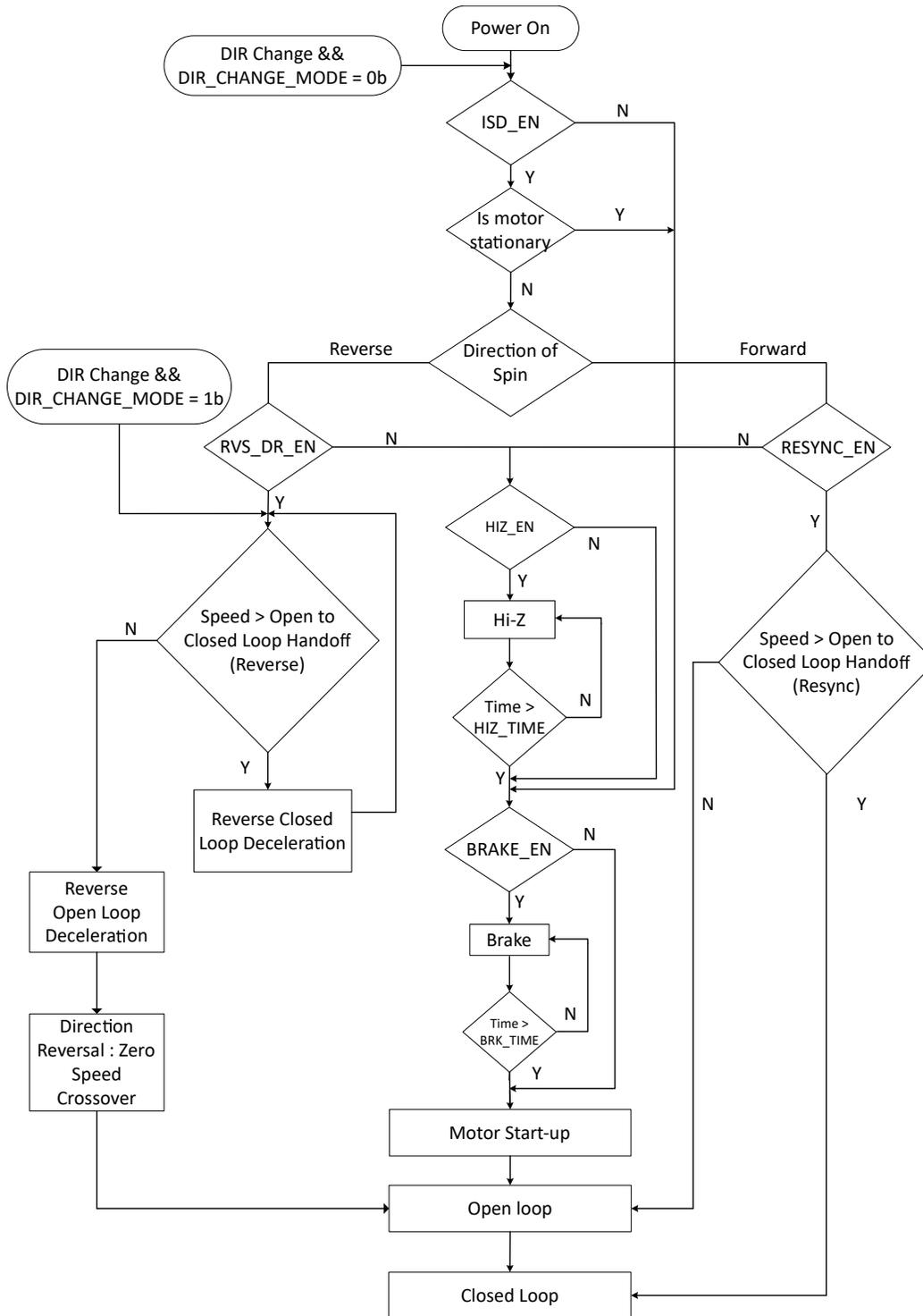
图 6-19. 电机启动流程
