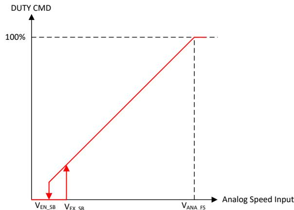
图 6-5. 模拟模式速度控制
