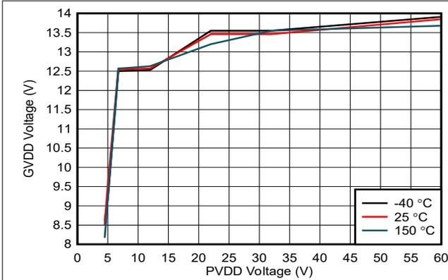
图 5-1. GVDD 电压与 PVDD 电压之间的关系
