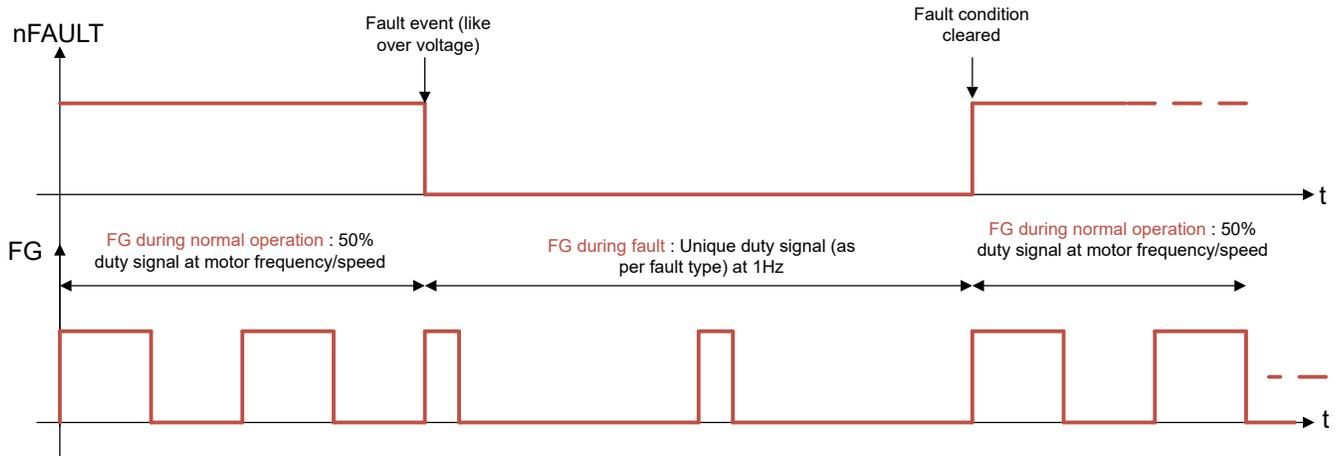
图 6-45. 通过 FG 进行故障指示
