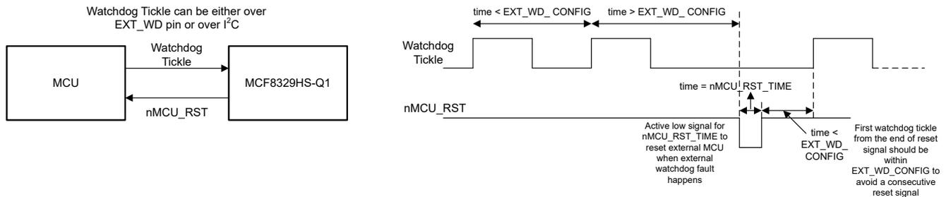
图 6-51. 外部看门狗故障时的 MCU 复位信号
