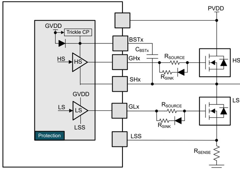
图 9-3. 具有独立拉电流路径和灌电流路径的栅极驱动器输出
