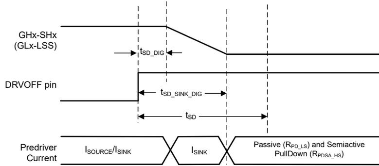
图 6-50. 栅极驱动器关断序列
