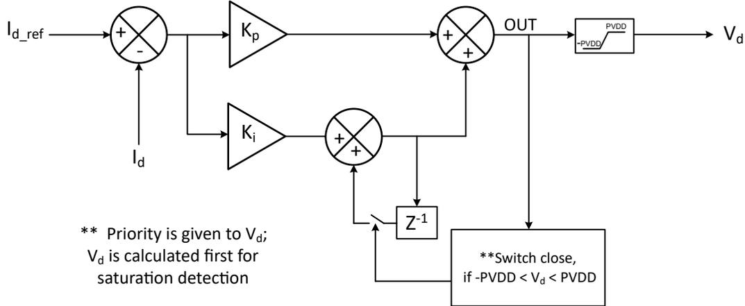
图 6-30.  $I_d$  电流 PI 控制
