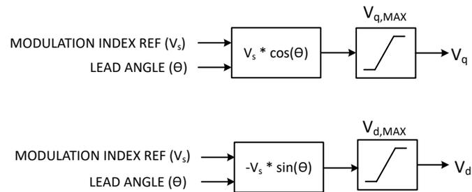
图 6-33. 开环电压控制
