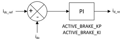
图 6-39.  $i_{d\_ref}$  的主动制动电流控制环路
