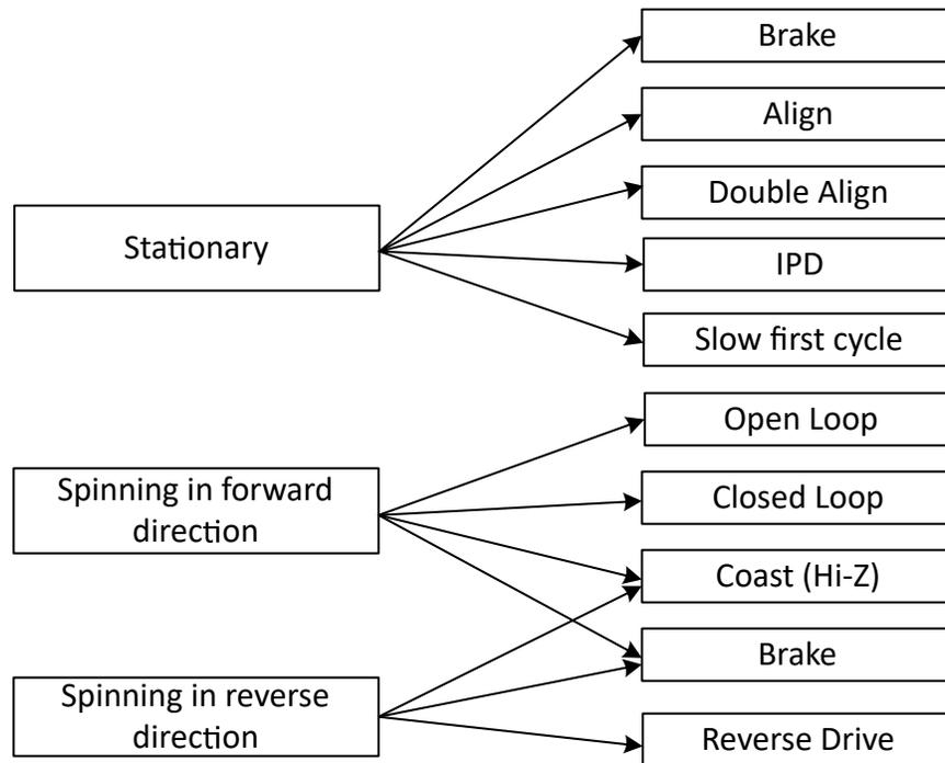
图 6-18. 在不同初始条件下启动电机
