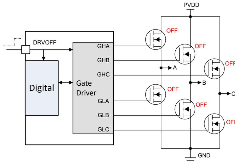
图 6-49. DRVOFF 栅极驱动器输出状态
