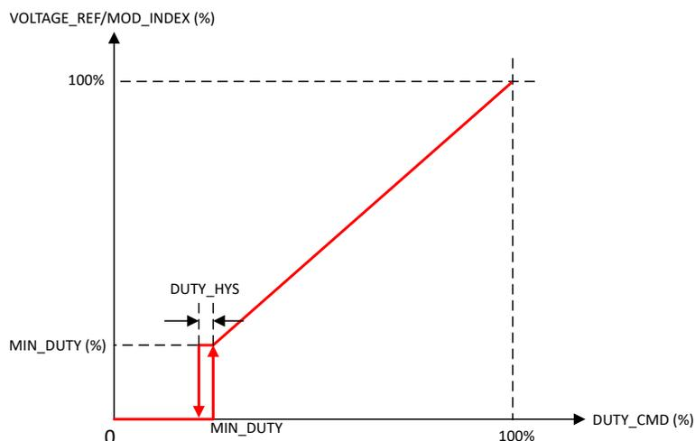
图 6-15. 电压基准传递函数
