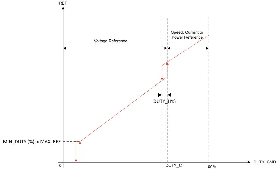
图 6-12. 多基准模式运行 ( 当 MIXED\_MODE\_CONFIG = 10b 时 )
