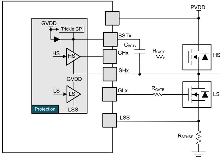
图 9-2. 具有串联电阻器的栅极驱动器输出
