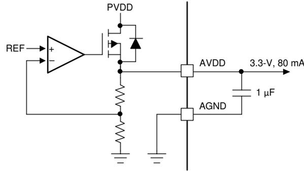
图 6-3. AVDD 线性稳压器方框图
