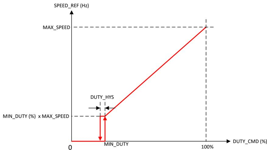
图 6-13. 速度基准传递函数
