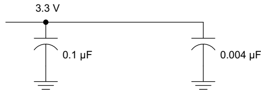
图 9-2. 建议的 M-LVDS 旁路电容器布局
