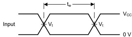
图 6-2. 电压波形，脉冲持续时间
