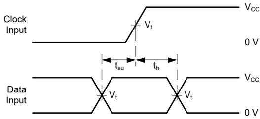
图 6-3. 电压波形，设置和保持时间
