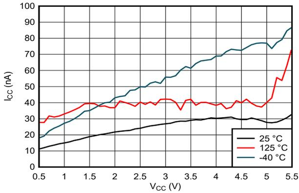
图 5-2. 电源电压两端的电源电流
