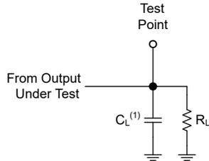
(1)  $C_L$  包括探头和测试夹具电容。
