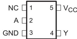
图 4-3. DRL Package 5-Pin SOT Top View
