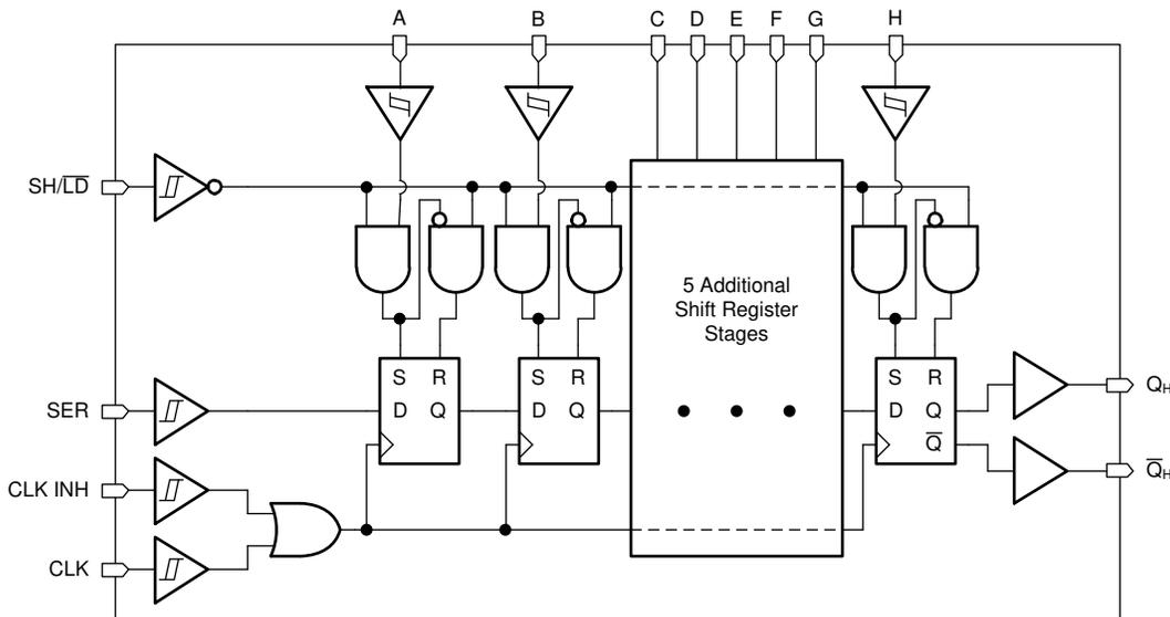
图 8-1. Logic Diagram (Positive Logic) for SN74HCS165-Q1
