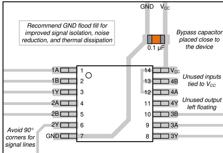
图 8-3. SN74LV4T32-EP 的示例布局
