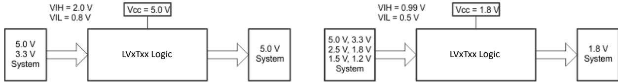
图 7-3. LVxT 升压和降压转换示例
