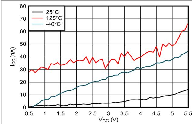
图 5-3. 电源电压两端的电源电流
