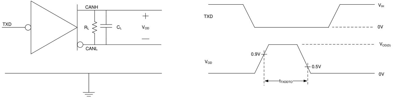
图 6-7. TXD 显性超时测试电路与测量
