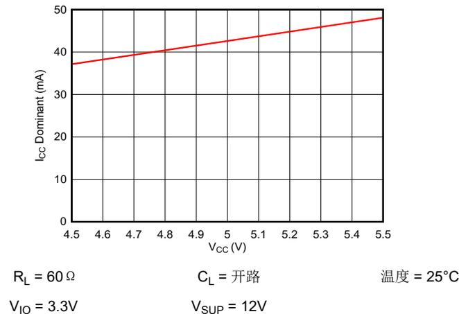
图 8-4. 显性模式下的电流消耗 ( $I_{CC(D)}$ ) 与  $V_{CC}$  电源间的关系
