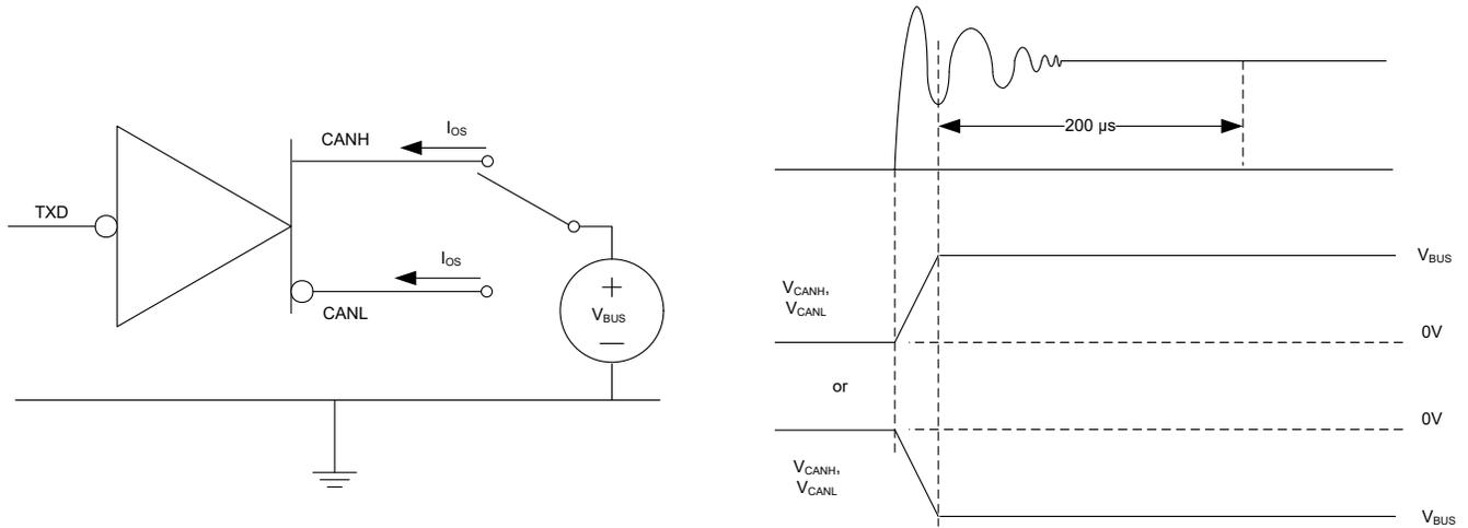
图 6-8. 驱动器短路电流测试与测量
