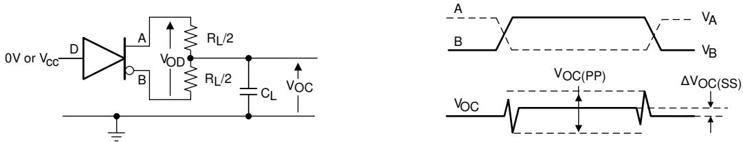
图 6-2. 具有 RS-485 负载的驱动器差分 and 共模输出的测量
