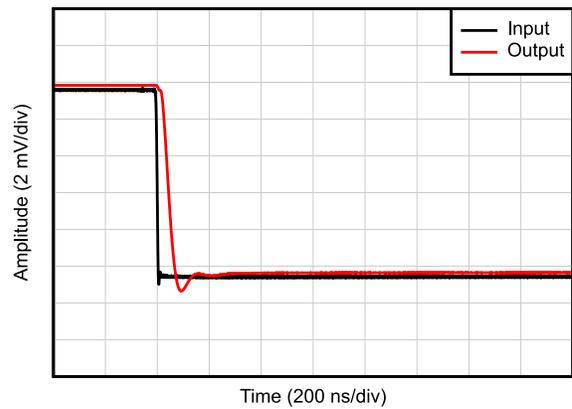
$C_L = 20\text{pF}$ ,  $G = 1$ , 10mV 阶跃响应
