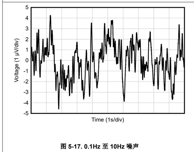
图 5-17. 0.1Hz 至 10Hz 噪声
