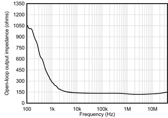
图 5-8. 开环输出阻抗与频率间的关系
