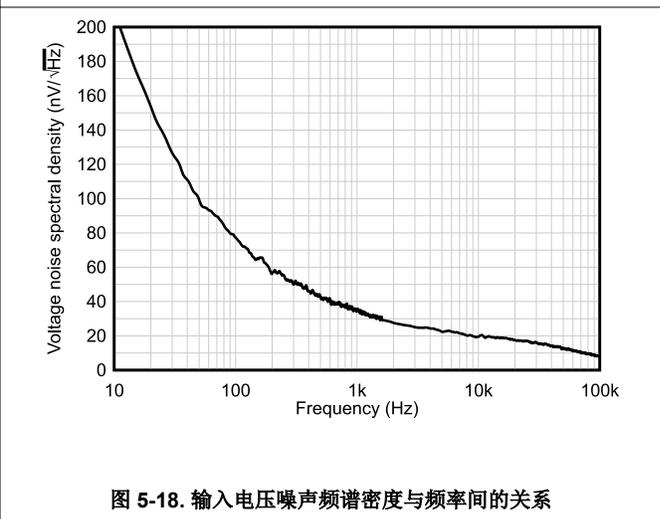
图 5-18. 输入电压噪声频谱密度与频率间的关系
