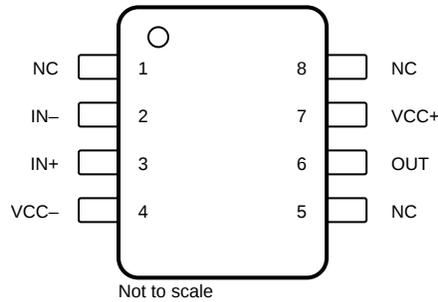
图 4-3. TL081x : D 封装 , 8 引脚 SOIC ,
