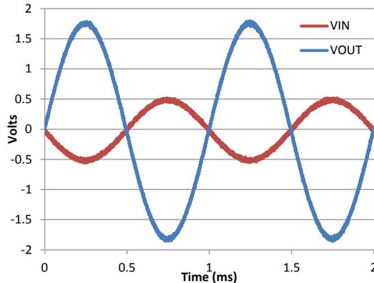
图 8-2. 反相放大器的输入和输出电压
