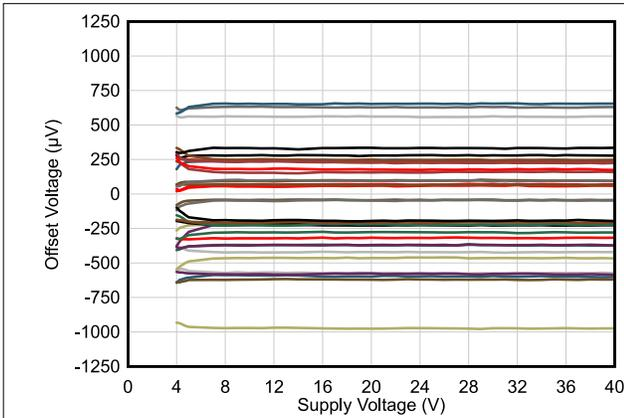
图 5-7. 失调电压与电源间的关系
