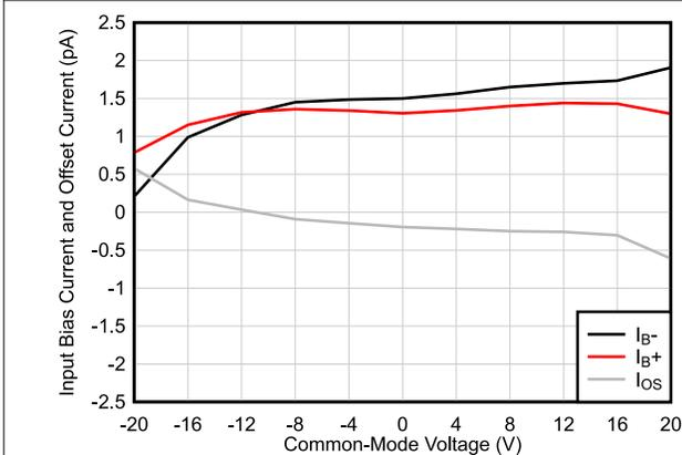
图 5-11. 输入偏置电流与共模电压间的关系
