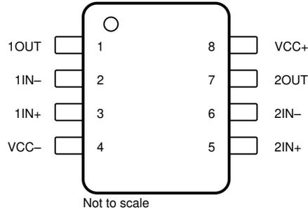
图 4-5. TL082x D , DDF , DGK , JG , P , PS 和 PW 封装 ,
