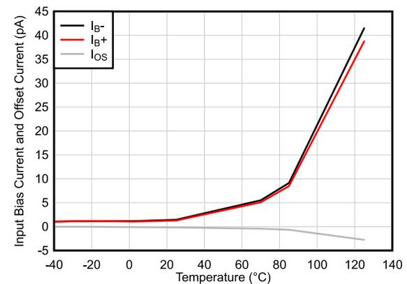
图 5-12. 输入偏置电流与温度间的关系
