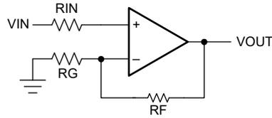
图 8-4. 非反相配置的运算放大器原理图
