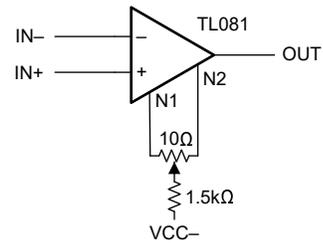
图 6-4. 测试图 4 (仅适用于 SO 封装)
