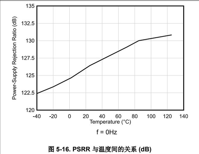
图 5-16. PSRR 与温度间的关系 (dB)
