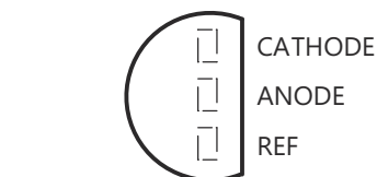
图 4-2. LP 封装 3 引脚 TO-92 顶视图
