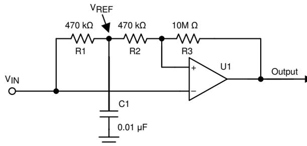
图 7-18. 使用 TLV903x 的脉冲切片器
