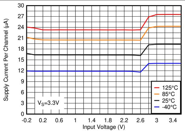
图 5-4. 电源电流与输入电压间的关系, 3.3V
