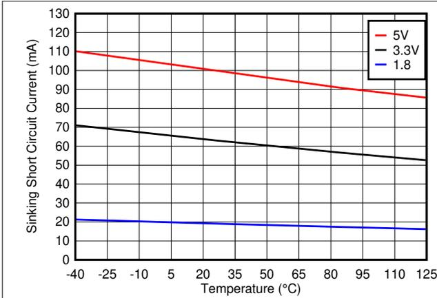
图 5-13. 短路灌电流与温度间的关系
