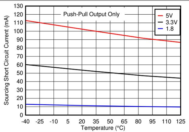
图 5-14. 短路拉电流与温度间的关系
