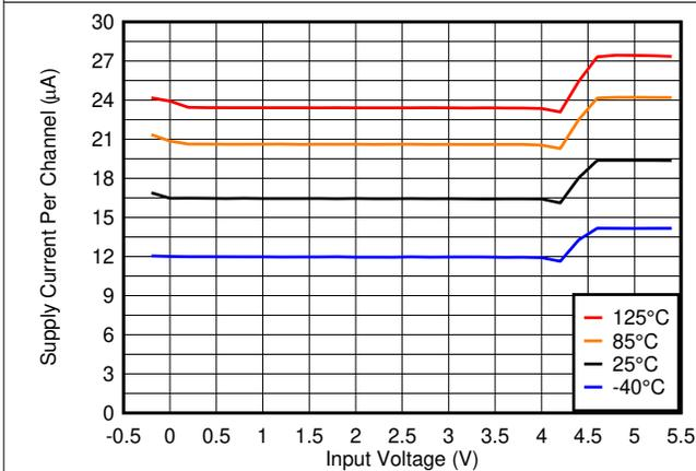
图 5-5. 电源电流与输入电压间的关系, 5V
