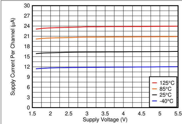
图 5-1. 电源电流与电源电压间的关系
