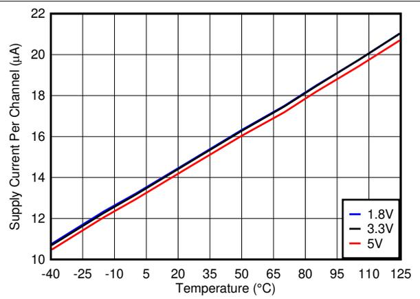
图 5-2. 电源电流与温度间的关系
