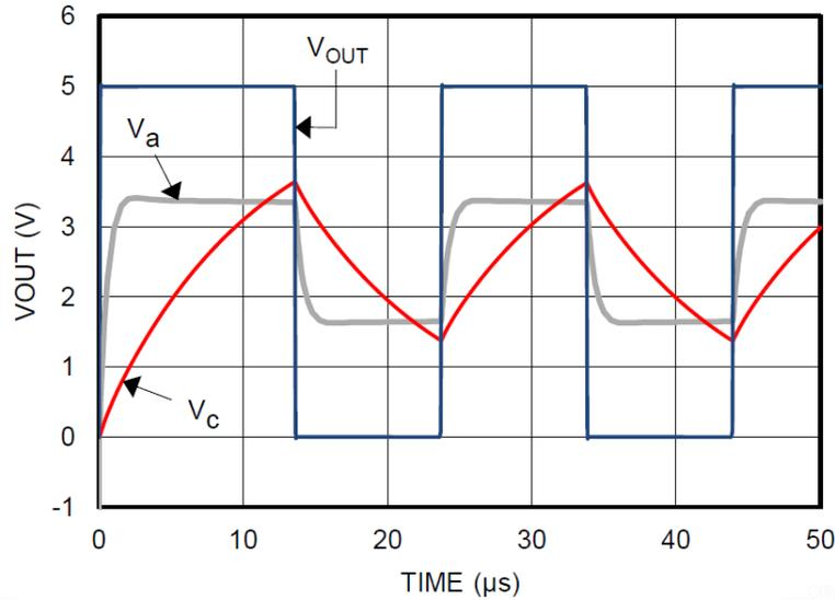
图 7-11. 方波振荡器输出波形
