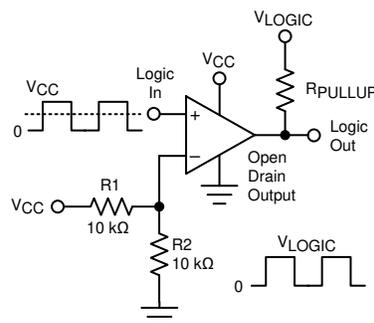
图 7-14. 通用逻辑电平转换器
