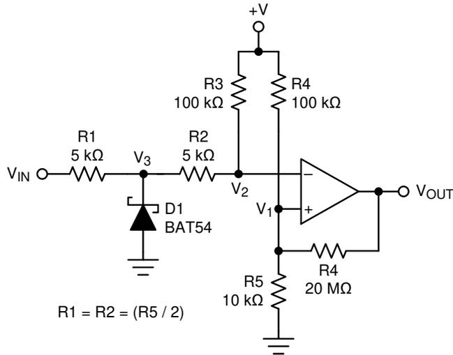
图 7-17. 过零检测器
