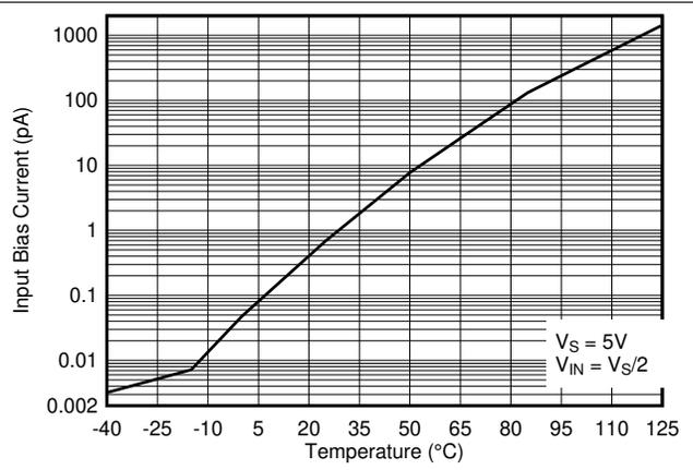
图 5-6. 输入偏置电流与温度间的关系
