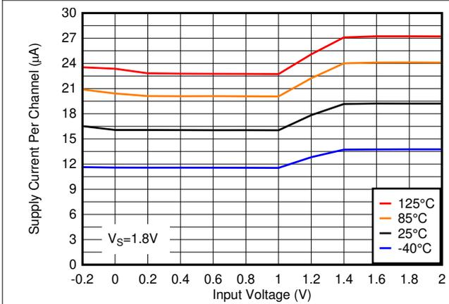
图 5-3. 电源电流与输入电压间的关系, 1.8V
