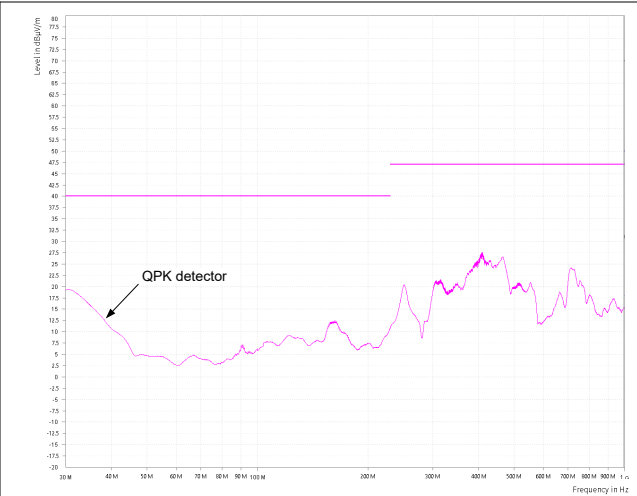
图 9-9. 符合 CISPR 32 B 类辐射发射限制：垂直极化
