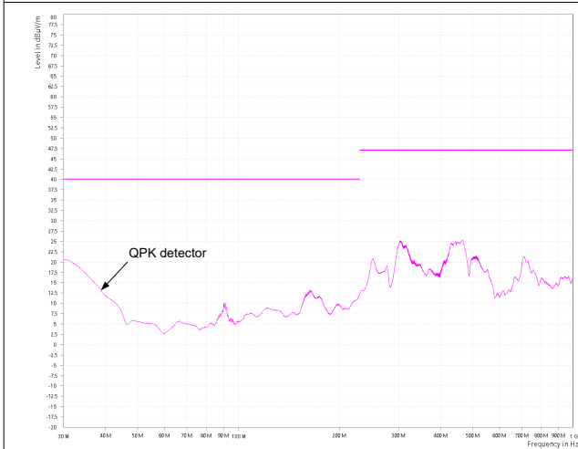
图 9-10. 符合 CISPR 32 B 类辐射发射限制 : 水平极化
