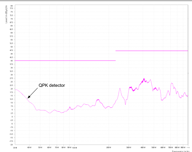
图 9-11. 符合 CISPR 32 B 类辐射发射限制 : 垂直极化
