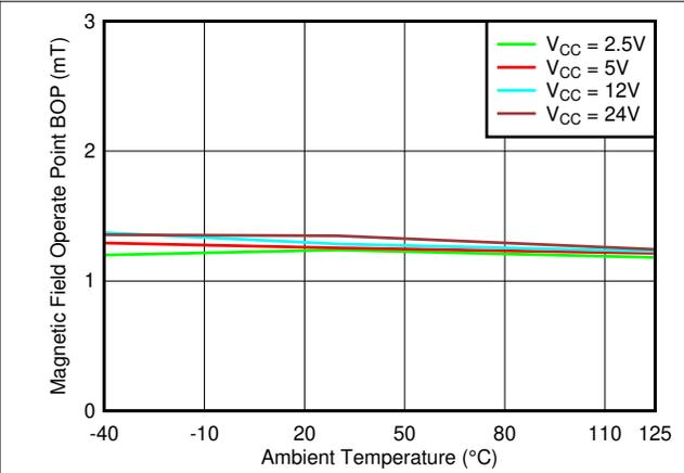
图 7-2. B<sub>OP\_Z</sub> 阈值与温度
