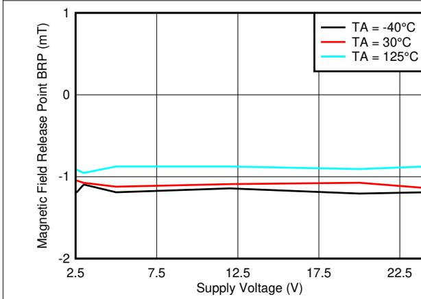
图 7-3. B<sub>RP\_Z</sub> 阈值与 V<sub>CC</sub>
