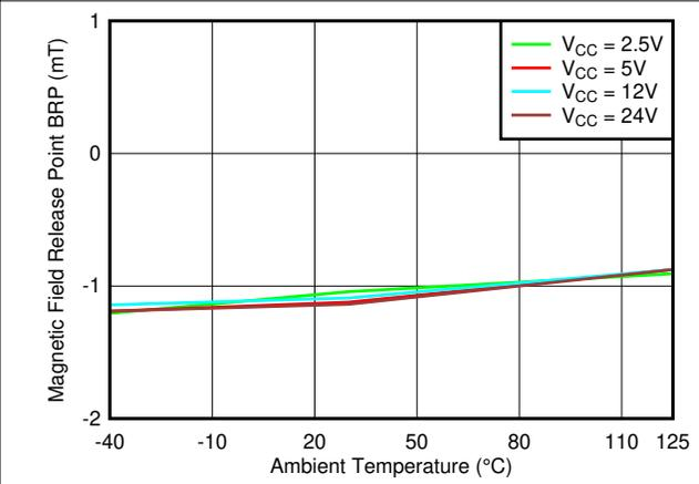
图 7-4. B<sub>RP\_Z</sub> 阈值与温度
