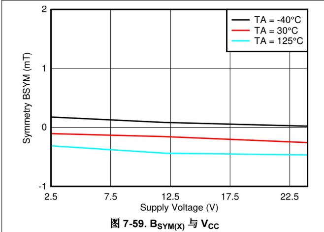
图 7-59.  $B_{SYM(X)}$  与  $V_{CC}$
