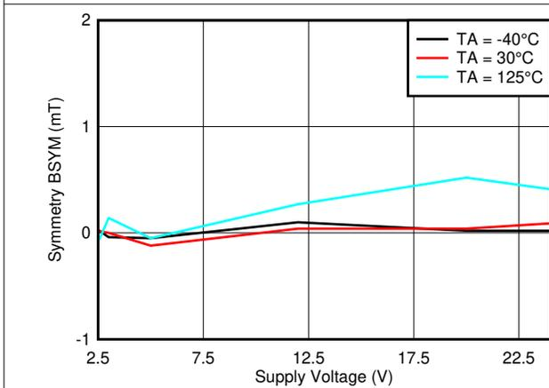
图 7-21.  $B_{SYM(X)}$  与  $V_{CC}$
