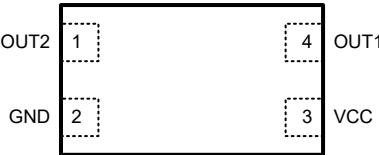
图 5-2. ZFC 封装，4 引脚 X1LGA ( 顶视图 )
