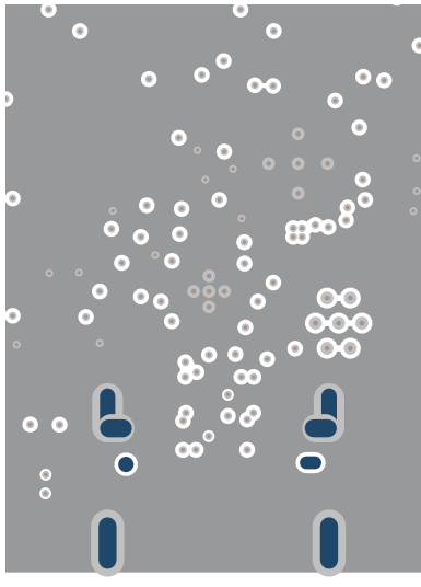
图 7-6. TPS26750 PCB 布局 - GND 层 2
