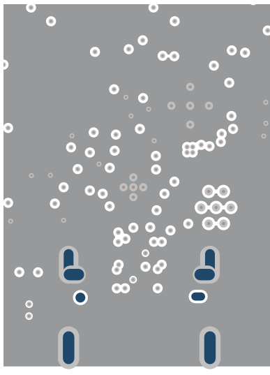
图 7-9. TPS26750 PCB 布局 - GND 层 5
