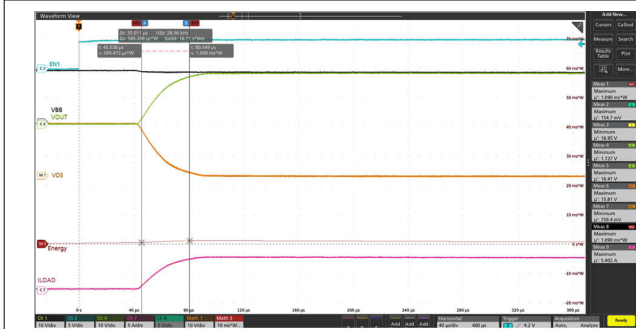
VBB = 13.5V I OUT1 = 5A T AMB = 25°C V EN = 0V 至 5V
