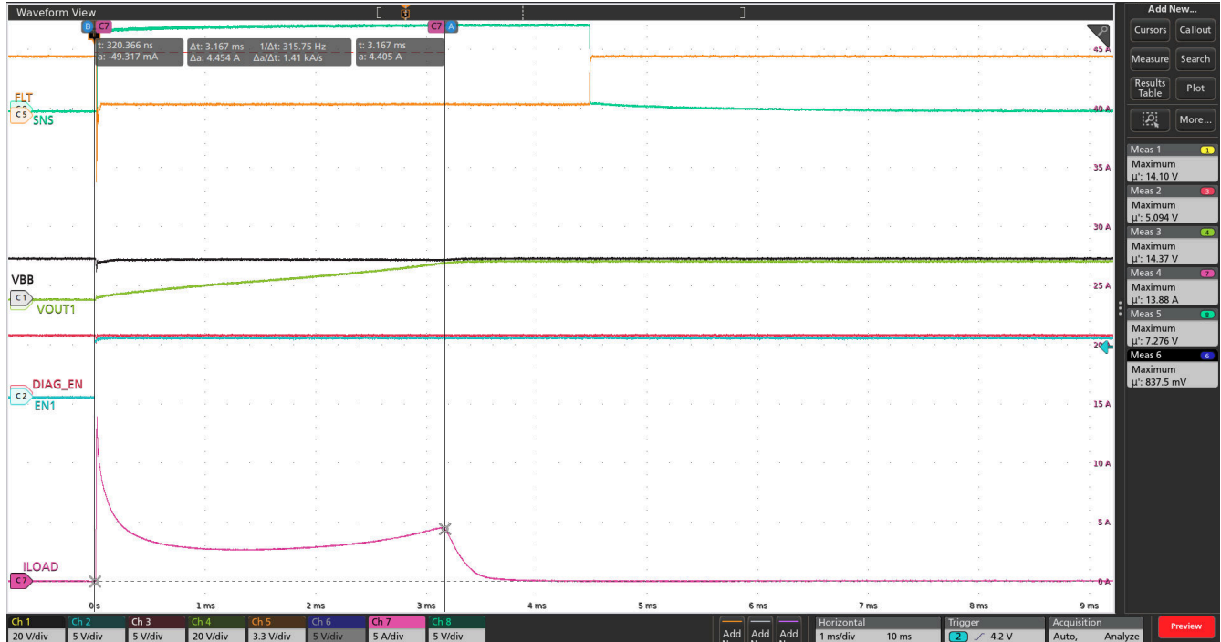
图 8-29. TPS1HC08-Q1 器件在 13.5V VBB、ILIM 引脚开路 and 125°C 环境温度下，进行 1mF 容性负载充电
