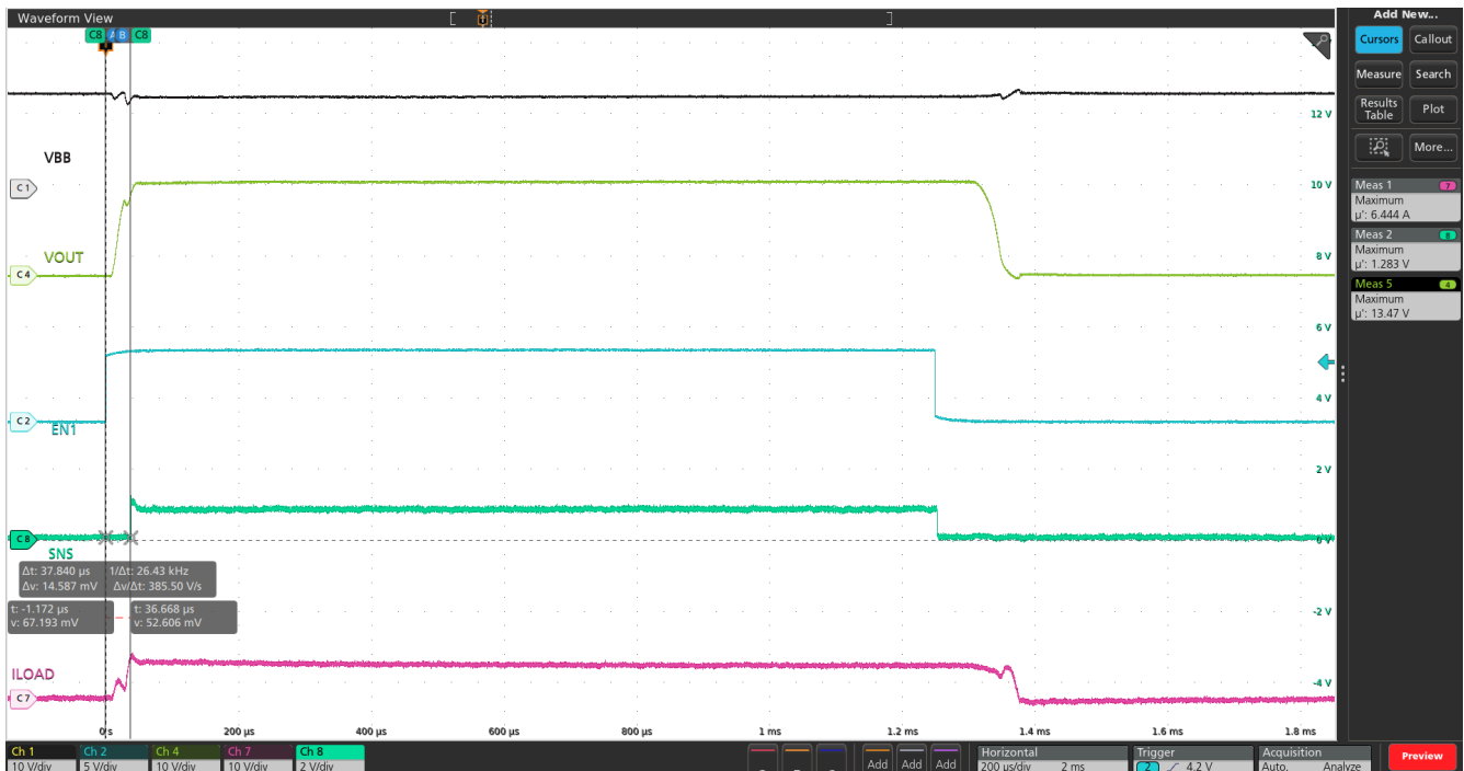
图 8-6. EN 触发的 SNS 响应时间 ( t_{\text{SNSION3}} )
