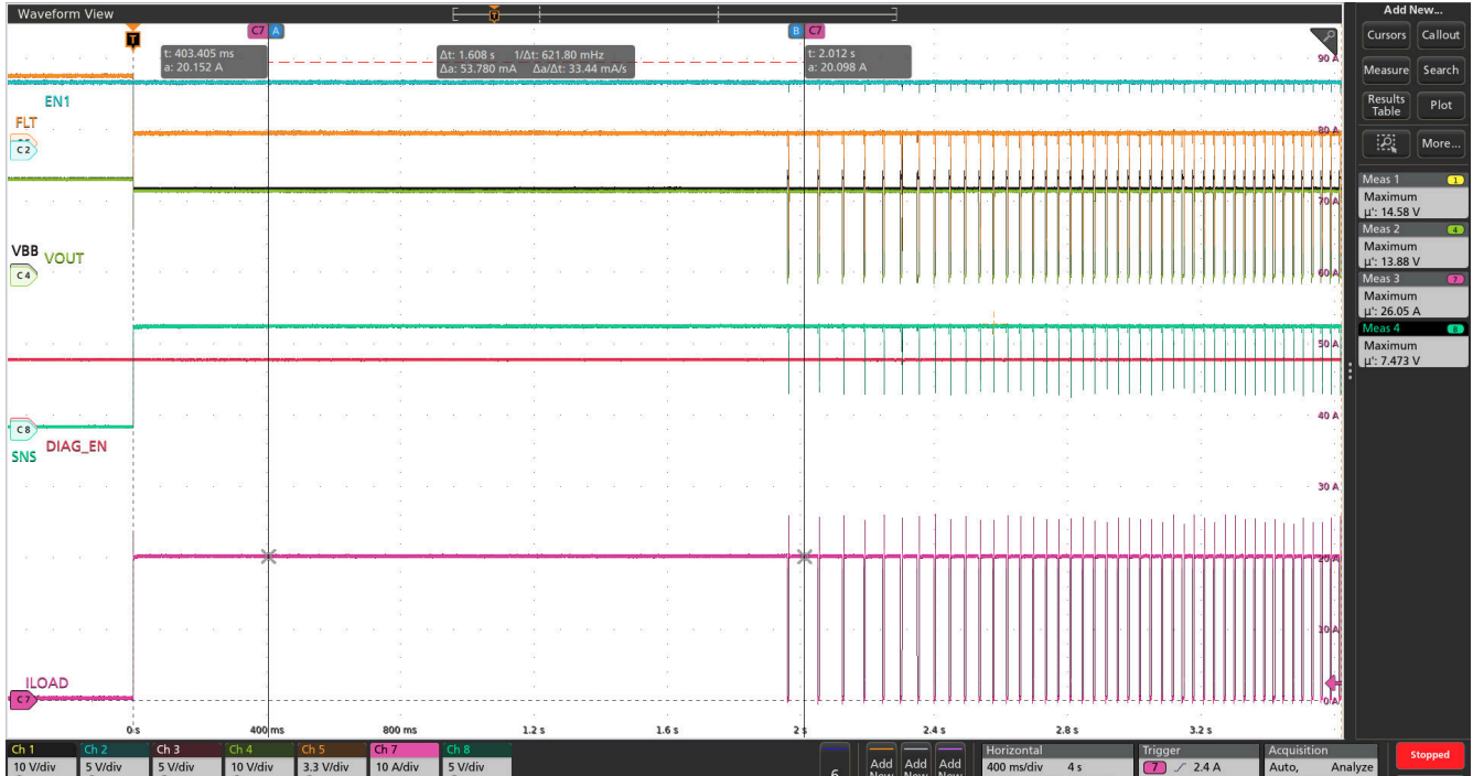
图 8-18. 对于负载电流 (20A 电子负载) 小于电流限制 ( I_{LIM} = GND ) 的情况, 器件进入无限热关断重试阶段
