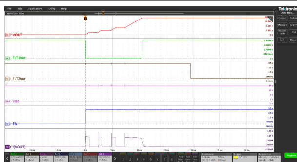
图 8-6. 在温度为 125°C、电流限制为 1A 时，为 220 \mu F 电容器充电
