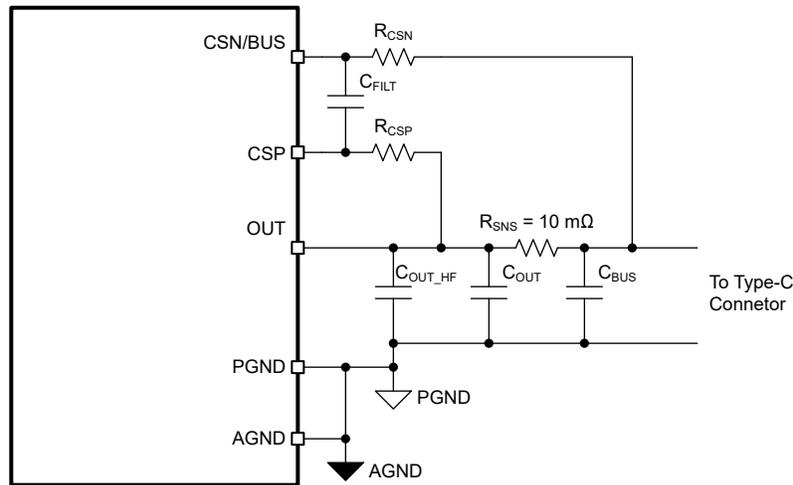
图 10-5. Current Sense Amplifier: RC Filter Components
