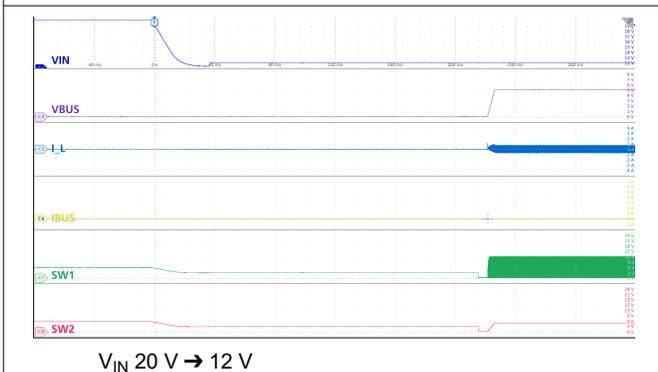
图 10-28.  $V_{IN(OVP)}$  Recovery
