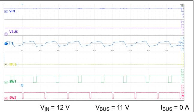
图 10-23. Buck-Boost Mode:  $V_{IN} \neq V_{BUS}$ , No Load
