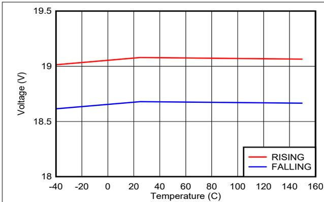
图 7-7.  $V_{IN(OVP)}$  vs Temperature
