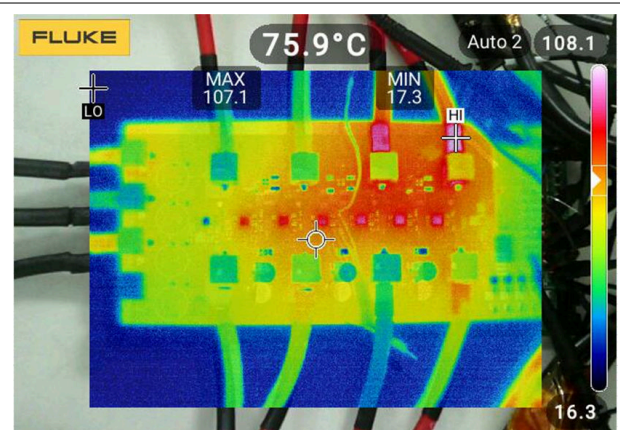
图 8-10. 并联六个器件的温升实验 (室温、无气流、总直流电流为 300A)
