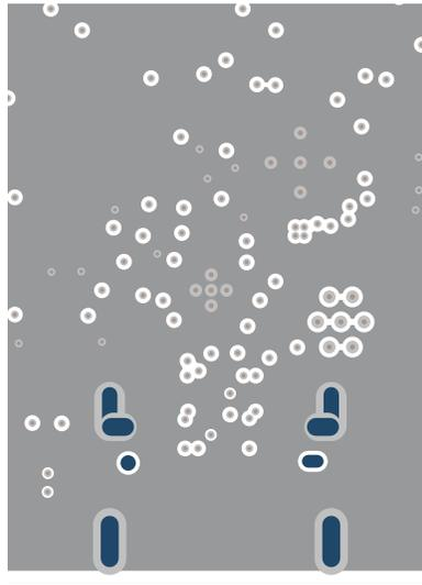
图 8-31. TPS26750 PCB 布局 - GND 层 5
