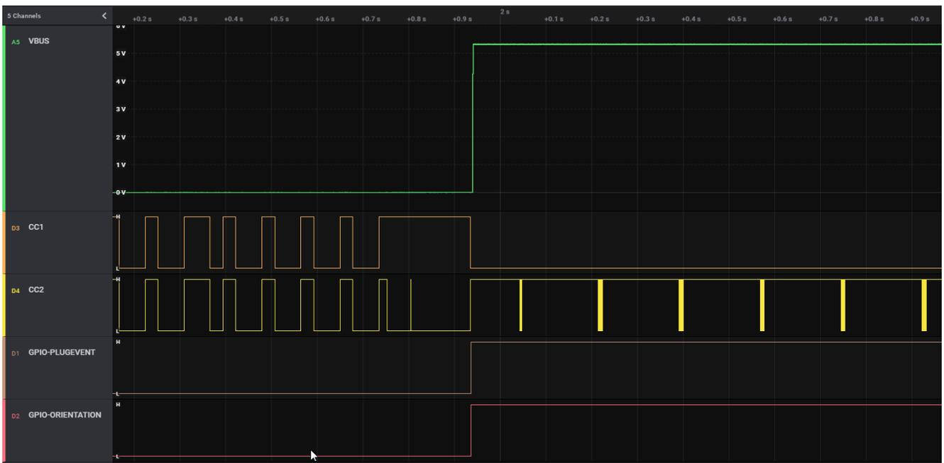
图 8-21. USB SuperSpeed 多路复用器控制 - 翻转方向
